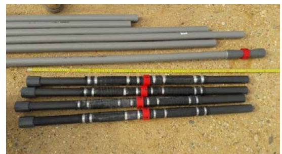
Figure 6.7 - Bagues de tassomètres magnétiques pour pose en forage (crédit photographique : GEOTEC)
