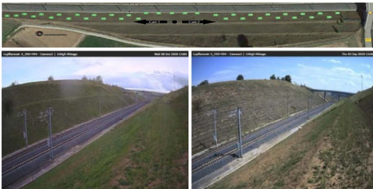
Positionnement des tiltmètres et vue du site par les caméras de la centrale d'acquisition
