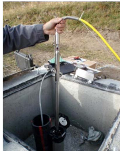
Figure 6.10 - Mesure à la sonde inclino- métrique (crédit photographique : EDF)
