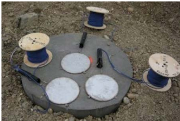
Cellules de pression totale sur les têtes d'inclusions
