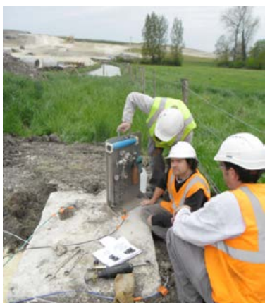
Figure 6.6 - Tranchée et extrémité de boules tassométriques (crédit photographique : GEOTEC)
