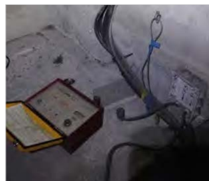
Mesures des appuis dynamométriques Reston
