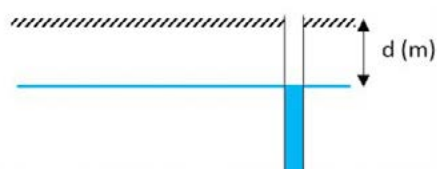
Figure 3.7 - Représentation de la mesure d'un niveau d'eau dans le sol.
