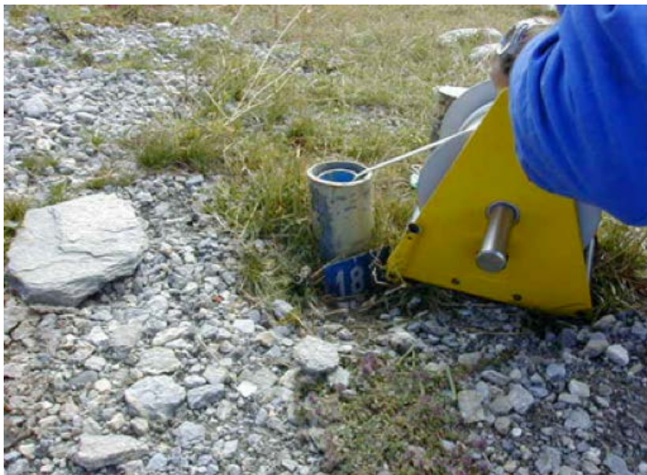
Figure 6.9 - Mesure au piézomètre avec une sonde lumineuse (crédit photographique : EDF)
