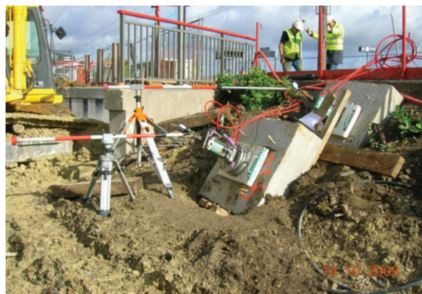
Photo 8.1a : massif de réaction en béton pour essai à la rupture (© SMG)
