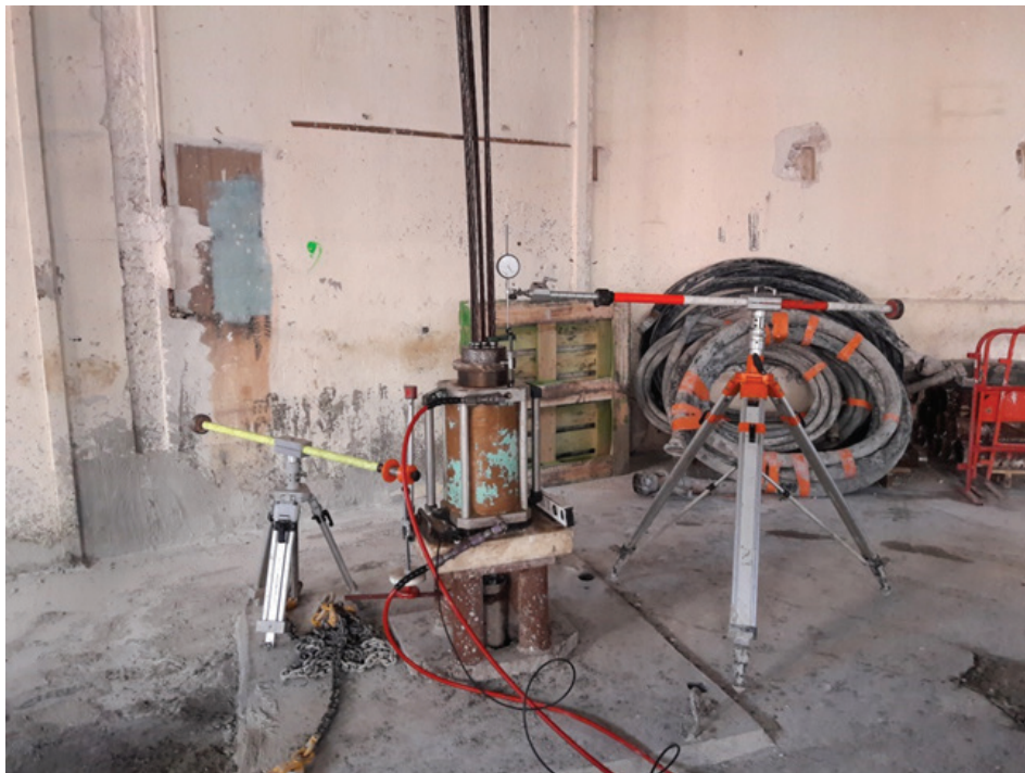
Photo I.5 : Dispositif de mesure des déplacements (© Spie Fondations)
