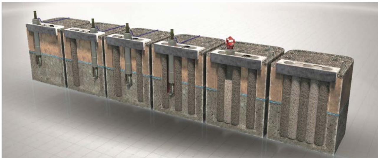
Figure 14. Séquençage de principe pour la réalisation de pieux sécants / Solétanche-Bachy
