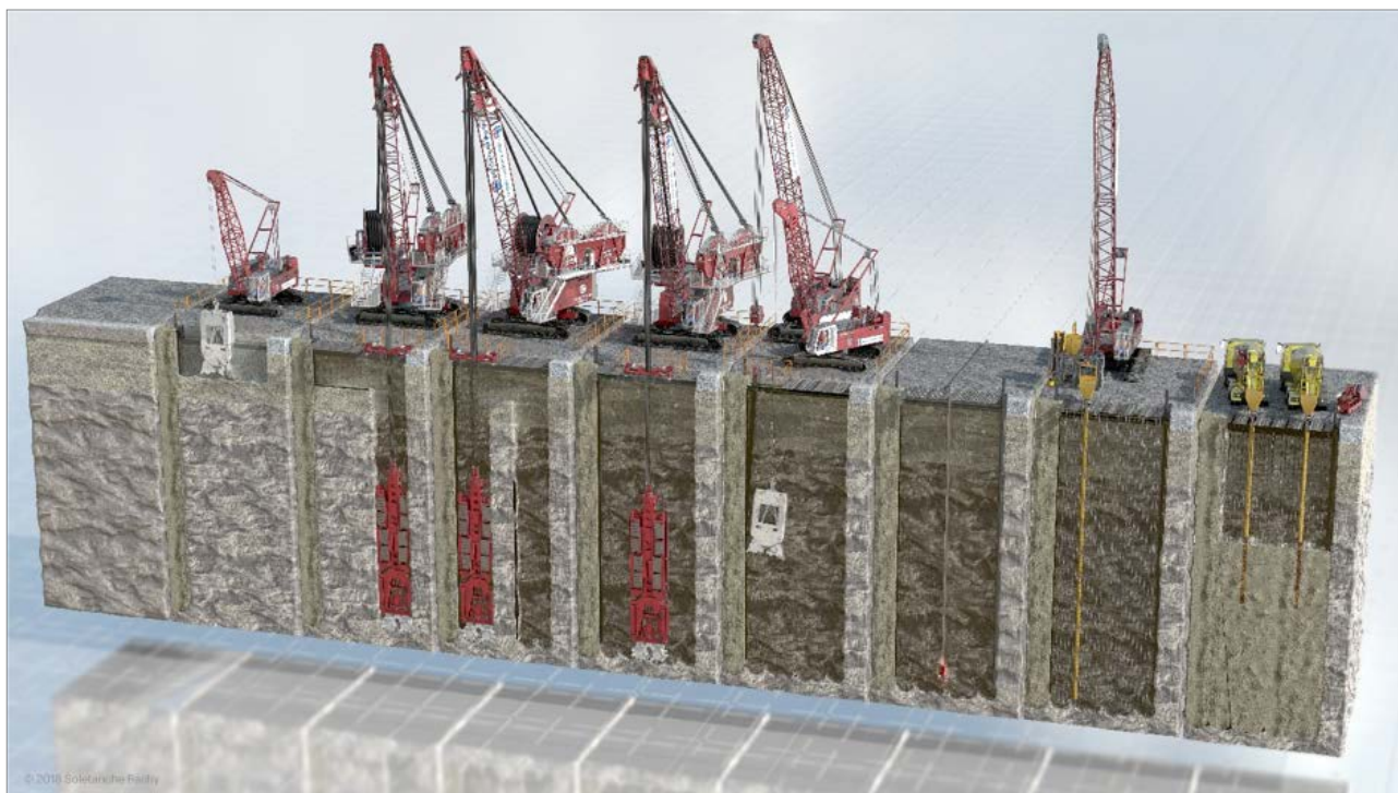
Figure 13. Séquençage de principe pour la réalisation d'une paroi moulée à l'hydrofraise / Solétanche-Bachy
