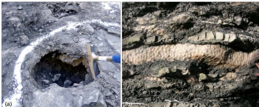
Photographie 16. Figures de dissolution de gypse lors d'un rabattement de nappe / EDF
