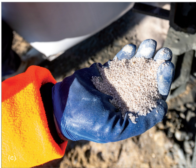
Photographie 21. Billes de verre (a) et une fois mises en place (b), comparé à un gravier filtre (c) et (d) / Cotrasol
