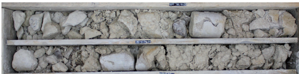
L15E_CHA-AVP-SC04281_Bancs ou fragments de calcaire dur et calcaire tendre très altéré. Ensemble détruit
