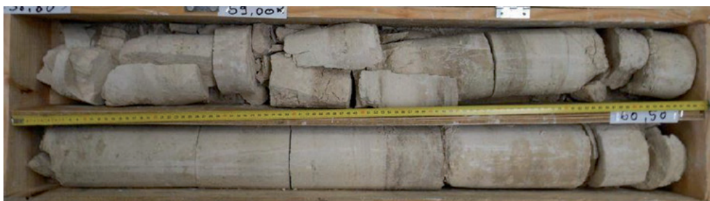
L16_LIG-AVP-SC2082_Calcaire semi-rocheux "profond" non altéré. Fracturation verticale
