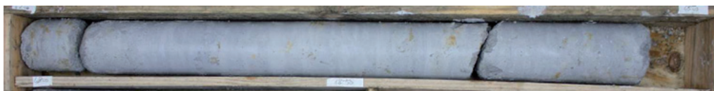
L150_NAN-PRO-SC04980_Calcaire fin et dur de la partie inférieure des Marnes de Meudon (= Calcaire montien), ici de 4,5 m minimum d'épaisseur
