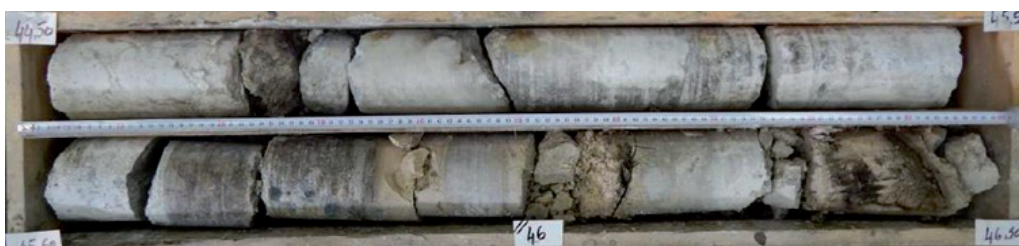
L16_SEV-AVP-SC2173_Gypse massif "alabastroïde" (et intercalations carbonatées beiges peu épaisses) au sein des Marnes et Caillasses
