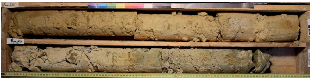
L18_ANT-AVP-SC02603_Faciès superficiel altéré
