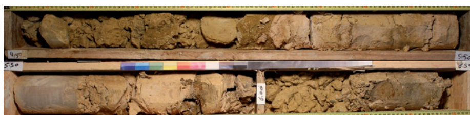
L18_ANT-AVP-SC02598_Faciès altéré avec élément de 15 cm de meulière siliceuse (en bas à gauche)
