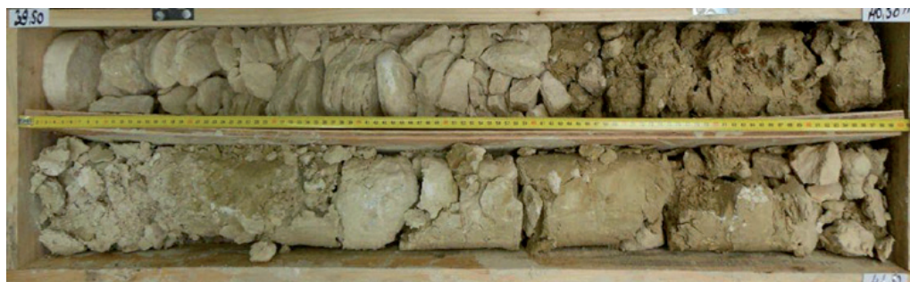
L16_CHL-AVP-SC0893_Gypse semi rocheux très fragmenté (en haut à gauche), et marnes tendre "déstructurées"
