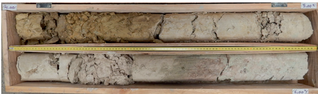
L17_TFE-AVP-SC1724_Sables verts (en haut à gauche) ici de teinte ocre, sur le Calcaire de Saint-Ouen
