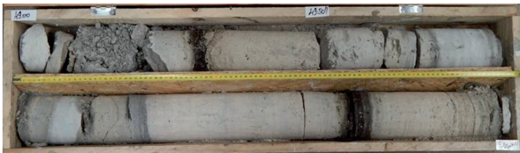
L16 STD-AVP-SC1484_Calcaire beige tendre, massif, avec intercalations plus claires et plus rocheuses (en haut à droite) et deux intercalations argileuses sombres. Faciès "standard" non altéré
