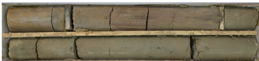
L15E_RSB-AVP-SC4290_Alluvions modernes argileuses très compactes
