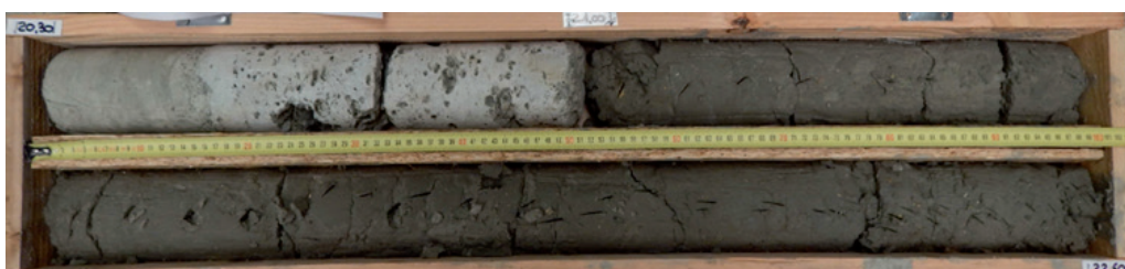
L17_TEF-AVP-SC3805bis. Banc de roche dure (principalement calcaire vacuolaire) dans les Sables de Beauchamp
