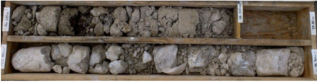
L15E_BOB-G11-SC027_Marnes et Caillasses avec gypse : ensemble très fragmenté et déstructuré (gypse en partie dissous ?)
