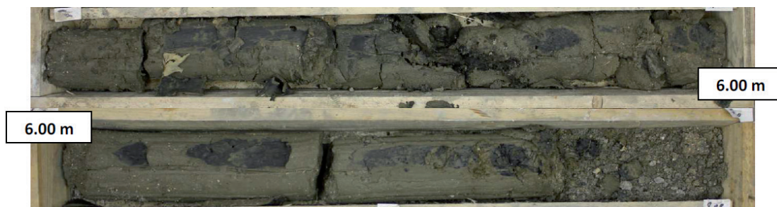
L15W_ISS-FAI-SC0227_Alluvions modernes essentiellement argileuses
