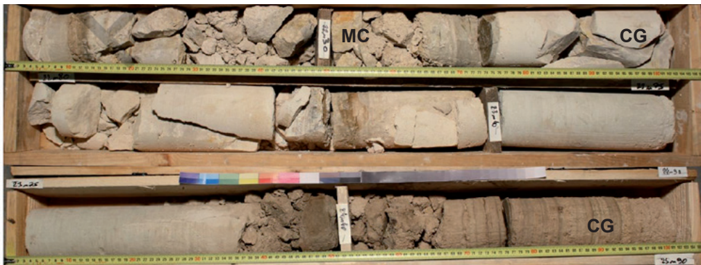
EOLE_SC5000_Sous la base rocheuse et fragmentée des Marnes et Caillasse, le sommet du Calcaire grossier est représenté sur environ 1,5 m par un calcaire fin, clair et dur (= Banc de Roche au moins en partie), fracturé, sur un calcaire beige-marron tendre et finement lité
