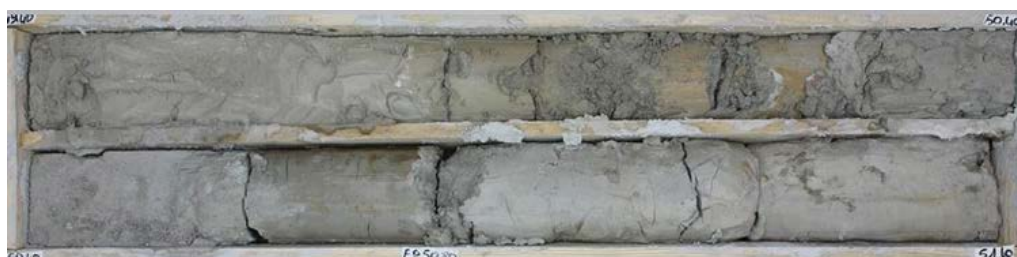
L15E_AVP_SC4211_Marnes et Caillasses : passée atypique de sable fin
