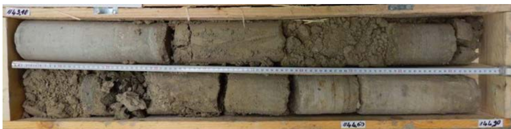
L16_CHL-AVP-SC2197_Alternance de Calcaire dur gris clair de calcaire tendre gris-marron et d'un faciès altéré sableux
