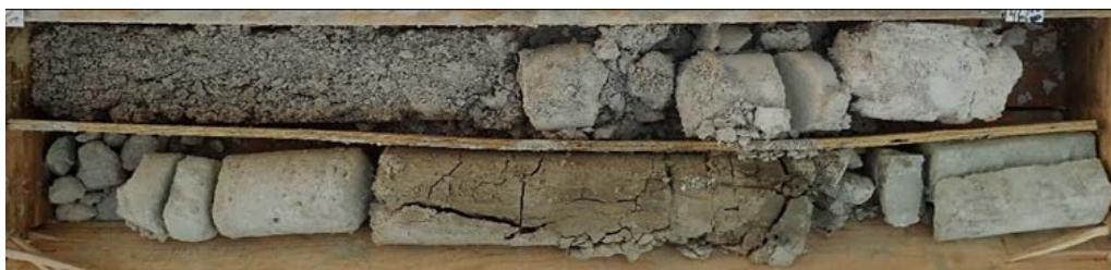
L16_STD-EXE-SC6155_Deux faciès atypiques au sein du Calcaire grossier (supérieur) : niveau sableux grossier (en haut à gauche) et passée marneuse (au milieu en bas). Bien que situé seulement 2 m sous le toit du CG, ce niveau marneux pourrait représenter le Banc vert
