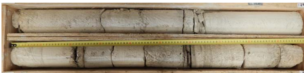
L17 VLP-AVP-SC3712_Faciès courant ou "standard" des calcaires de la formation des Marnes et Caillasses : calcaire beige semi-rocheux ("tendre") peu altéré assez homogène (quelques lits argileux fins)
