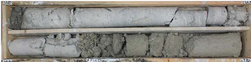
L15E_RSB-AVP-SC4211_Calcaire massif et passée sableuse gris-vert atypique dans les Marnes et Caillasses
