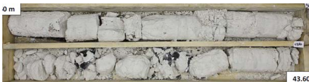
L15W_ISS-FAI-SC0227bis. Craie à deux niveaux de petits silex noirs, modérément altérée
