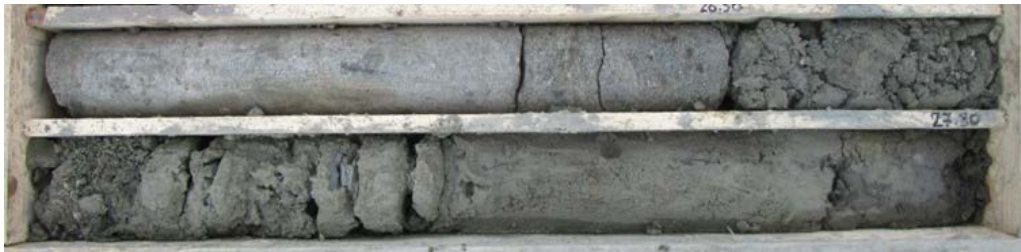
EOLE_EXE-SD/SC-5450_Niveau argileux atypique gris-verdâtre de 1,3 m en base du Calcaire grossier
