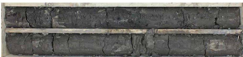
L15E_CHA-AVP-SC04268 (sous la Marne)_Alluvions modernes argileuses
