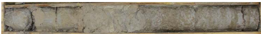
L15S_CHA-AVP-SC1907_Passée sableuse dans les marnes de Meudon, à rapporter à la formation des "Marnes à rognons"
