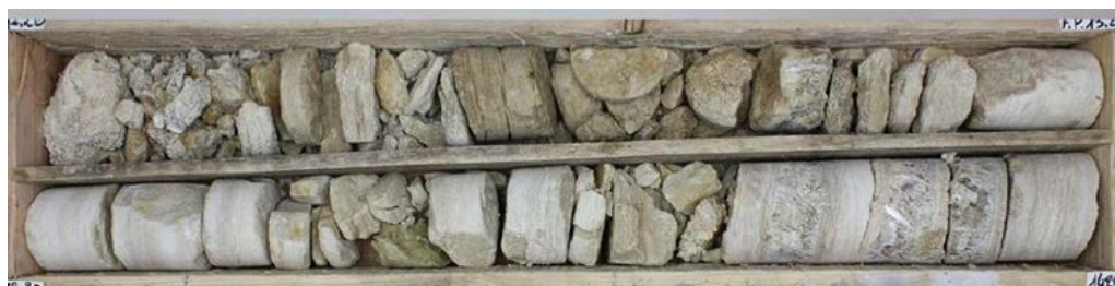
L15E_RSB-AVP-SC4203_Passée marno-calcaire et gypseuse hétérogène et fragmentée avec intercalations de gypse (Gy) en gros cristaux (cristaux en fer de lance)
