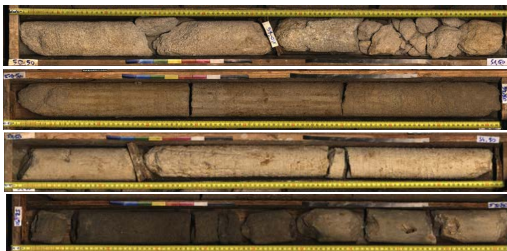
L150_NAN-FAI-SC00594_Sous les Marnes à rognons et au-dessus de la craie, succession de faciès calcaires rocheux et gréseux plus ou moins lités, alternativement clairs et plus ou moins foncés, avec une passée très foncée (possiblement ligniteuse et/ou pyriteuse) constituant un faciès énigmatique dans le "Montien" parisien. On ne peut exclure à ce stade qu'il ne s'agisse pas de Faciès sparnaciens. Il faudrait les étudier en pétrographie, minéralogie, chimie, palynologie et/ou biostratigraphie pour déterminer leurs conditions de dépôt et âge.
