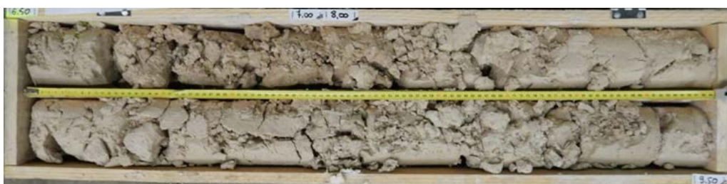
L17_TEF-AVP-SC3851_Calcaire altéré friable en partie désagrégé
