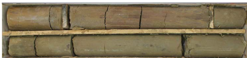
L15E_RSB-AVP-SC4290_Alluvions modernes argileuses très compactes
