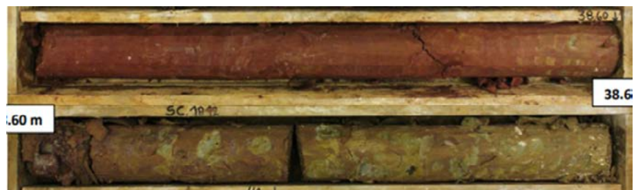
L15S_CAC-AVP-SC01812_Argile bariolée avec passée de teinte lie-de-vin très marquée
