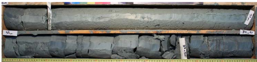
L18_ANT-AVP-SC02603_Marnes grises légèrement bleutées, homogènes (Marnes d'Argenteuil)
