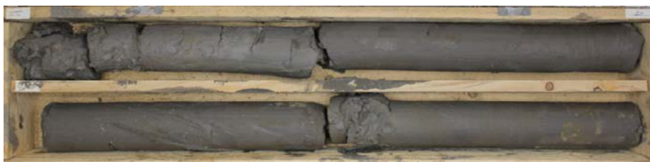
L14S_PAR-AVP-SC1292bis_Argiles grises de la partie supérieure de la formation de l'Argile plastique
