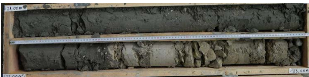
L17_VIL-AVP-SC1711_Passage tranché des Sables de Beauchamp aux Marnes et Caillasses
