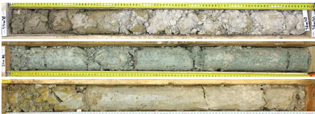
L15S_CHA-AVP-SC02704/SC2337/SC0111/SC1644 (de haut en bas). Différents faciès marneux (à argileux ?) intégrés dans la Formation de Meudon sur les leviers de sondages mais correspondant aux "Marnes à rognons"
