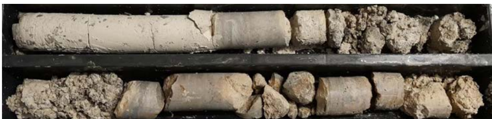
L15NE_SC8811_Alternance de calcaire tendre beige altéré et de calcaire dur probablement en partie silicifié
