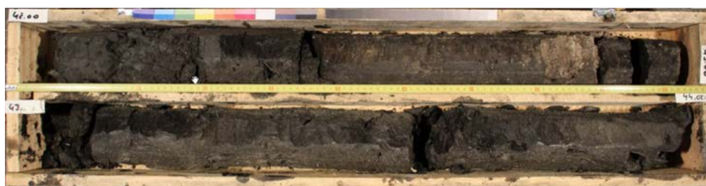
EOLE_PRO-SC5540_Argiles très sableuses (passées les plus claires) à très organiques (sombres, avec lignite) typiques des Fausses Glaises
