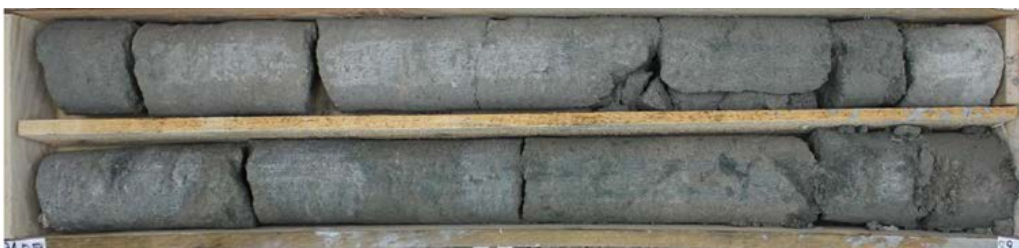
L15E_RSB-AVP-SC04290_Calcaire grossier inférieur gris-vert glauconieux
