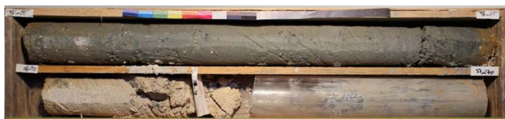
L18_PAL-AVP-SC02248_Faciès profond marno-argileux pas ou peu altéré
