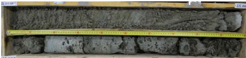
L15E_STD-AVP-SC1792_Calcaire dur et très vacuolaire intercalé dans du sable lâche
