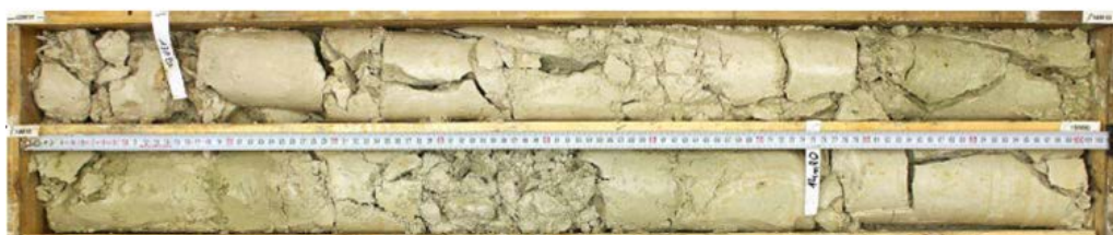
L16_NLG-AVP-SC0906_Marnes homogènes beiges
