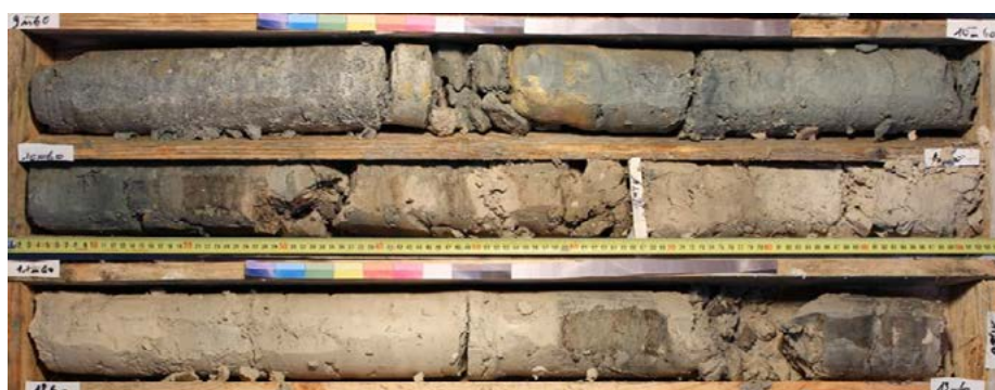
L18_ANT-AVP-SC02603_Faciès marneux à plus ou moins calcaire, peu altéré
