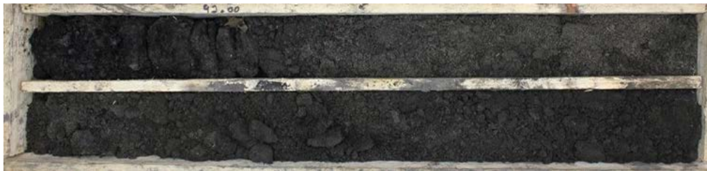
L15E_CHA-AVP-SC4268_Sable gris-noir un peu ligniteux (Sables supérieurs)
