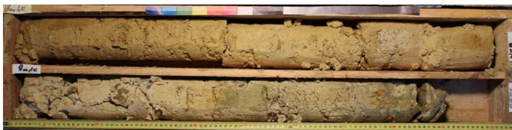
L18_ANT-AVP-SC02603_Faciès superficiel altéré
