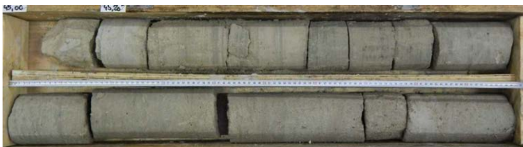
L16_SC1114_Calcaire gris-beige (parfois beige-marron) assez tendre fréquemment observé dans la partie "moyenne" du Calcaire grossier. Litage discret
