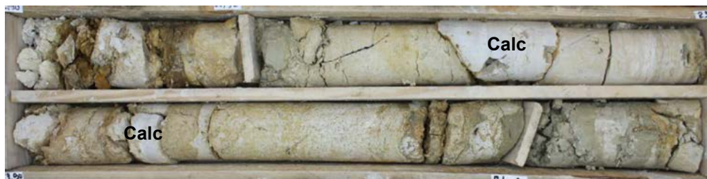
L15E_RSB-AVP-SC4290_Marnes (et/ou calcaire tendres) et intercalations de fragments de calcaire dur
