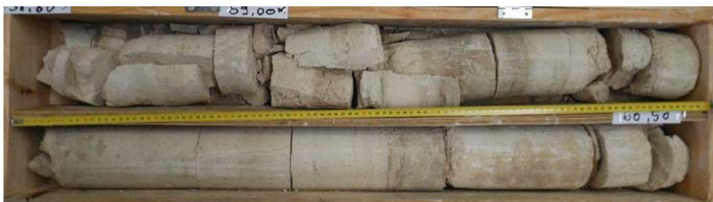
L16_LIG-AVP-SC2082_Calcaire semi-rocheux "profond" non altéré. Fracturation verticale
