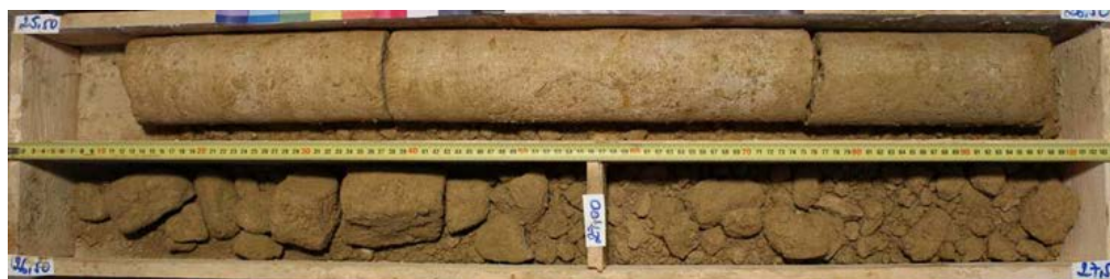
L15O_STC-AVP-SC01349_Calcaire massif et calcaire altéré désagrégé
