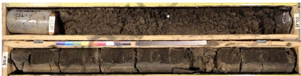
EOLE_SC7690_Sable brun lâche et argile brune assez compacte en position médiane dans l'Yprésien (rapportés aux Fausses glaises)
