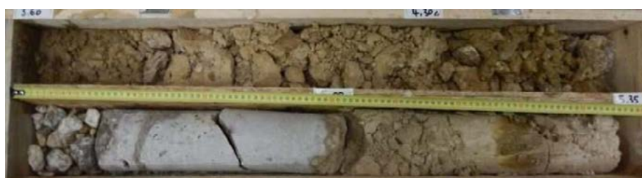
L16_MOF-PRO-SC3314_Banc de calcaire dur (± meulière siliceuse) et marnes/argiles altérées résiduelles "déstructurées"
