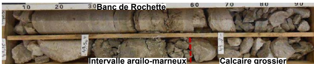
L15E_BOB-FAI-SC4651(SC0036)_Partie basale des Marnes et Caillasses avec Banc de Rochette probable
