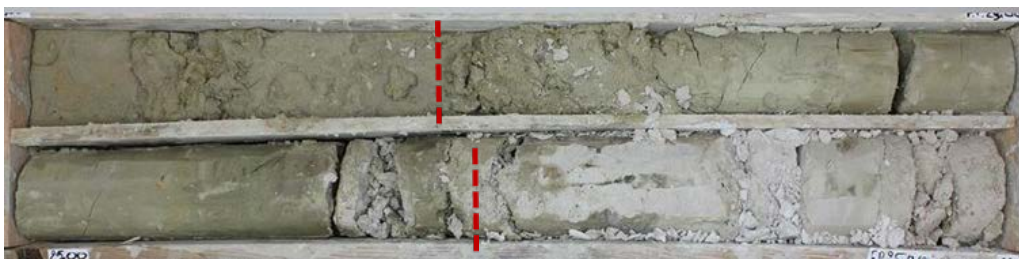
L15E_RSB-AVP-SC4203_Sables verts (entre les traits rouges en tiretés) : sables et marnes. Calcaire de Saint-Ouen en bas à droite
