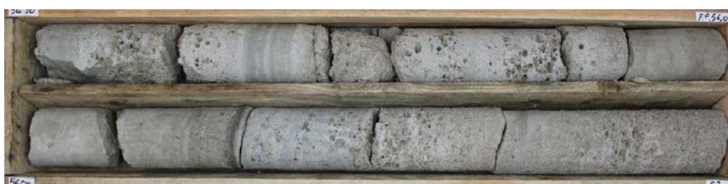
L15E_RSB-AVP-SC4203_Calcaire gris localement lité ou rubané et à passées très vacuolaires (dissolution de coquilles) régulièrement observées et définissant le caractère "grossier" du calcaire
