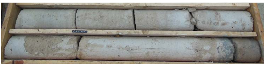
EOLE_SC7230_Faciès calcaire rocheux assez homogène
