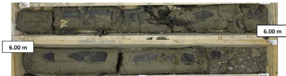
L15W_ISS-FAI-SC0227_Alluvions modernes essentiellement argileuses
