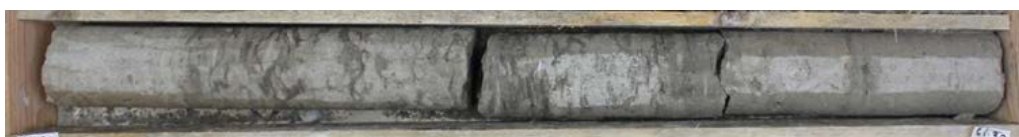
L15E_FSB-AVP-SC04302_Calcaire à passée noduleuse marbrée pluridécimétrique (faciès particulier)
