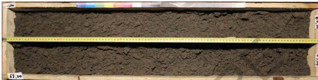
EOLE_SCI-SUP5540_Sable marron non ligniteux en position supérieure dans la formation (= Sables supérieurs)
