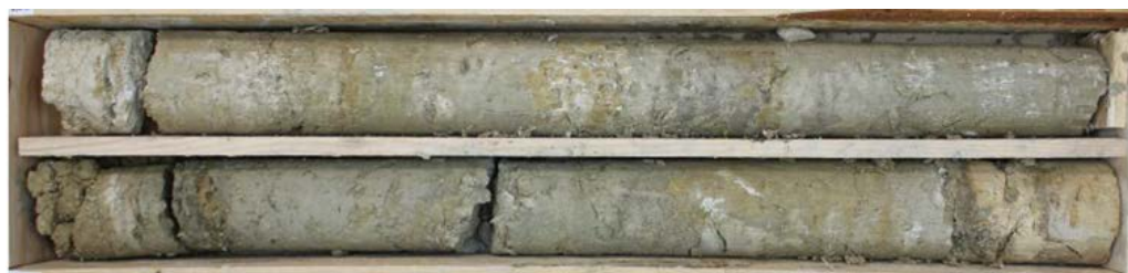
L15E_RSB-AVP-SC4203_Faciès marneux relictuel hétérogène mais compact et massif (avec fragments de gypse blanc préservé ?)
