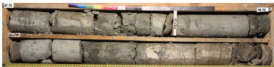
L18_PAL-AVP-SC02248_Faciès "profond" alternativement calcaire et marneux préservé de l'altération superficielle
