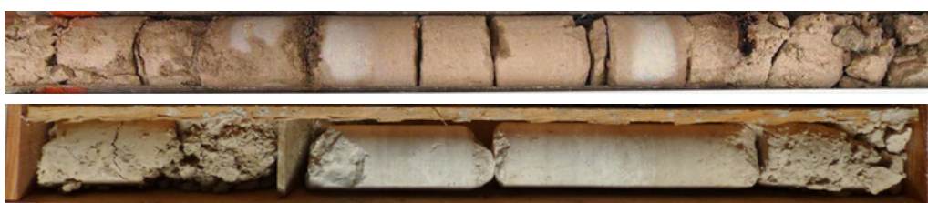
L15E_NSM-FAI-SC4713 et L16_LCO-EXE-SC06331_Bancs calcaires "durs" pluridécimétriques bien individualisés et calcaire tendre ou marnes
