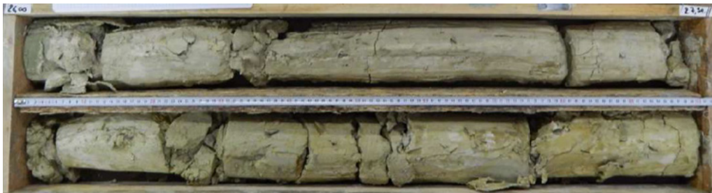
L16_CSM-PRO-SC332_Faciès carbonatés très tendres
