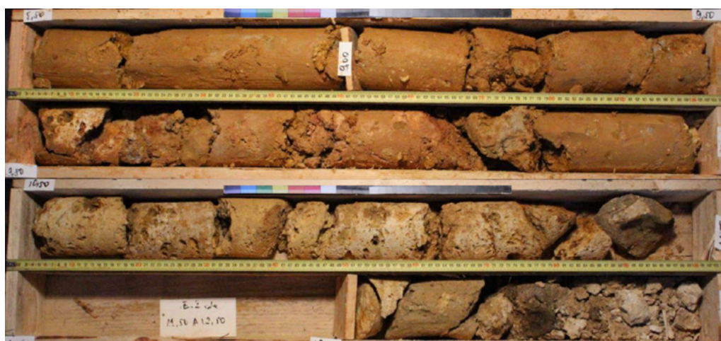
L18_GUY-AVP-SC03111_Meulière vacuaire sur près d'un mètre dans encaissant marno-argileux résiduel
