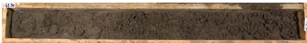
EOLE_SC-7500_Horizon sableux meuble et marron observé à la base de l'Yprésien et ainsi rapporté aux Sables d'Auteuil mais que l'on peut interpréter comme un horizon sableux de la base de Fausses glaises
