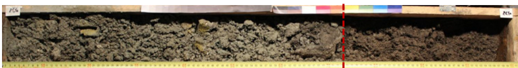
EOLE_PRO-SC-5550_Base du Calcaire grossier très désagrégée à sableuse (à gauche du trait repère) interprétée comme l'horizon de "Glaconie grossière" au-dessus des Sables supérieurs de l'Yprésien (à droite)
