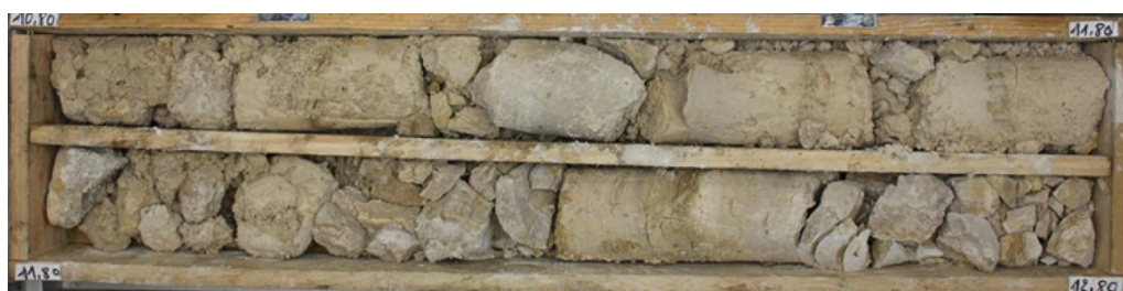
EOLE_PRO-SCI5440_Fragments de calcaire dur dans un faciès beige-ocre plus tendre et altéré de calcaire (marneux ?)
