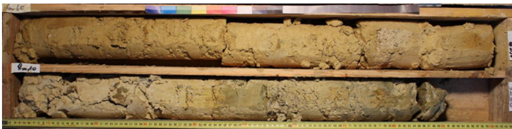
L18_ANT-AVP-SC02603_Faciès superficiel altéré
