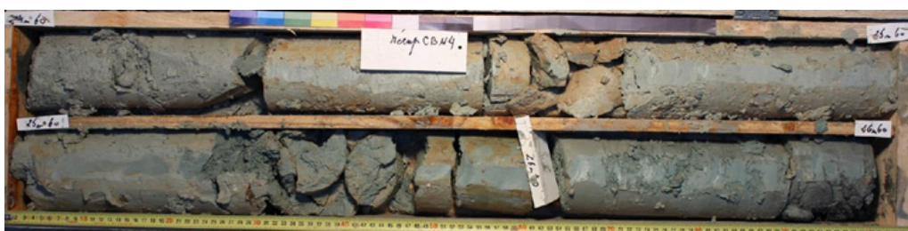
L18_ANT-AVP-SC02603_Faciès gris-bleuâtre des Marnes de Pantin évoquant les Marnes d'Argenteuil
