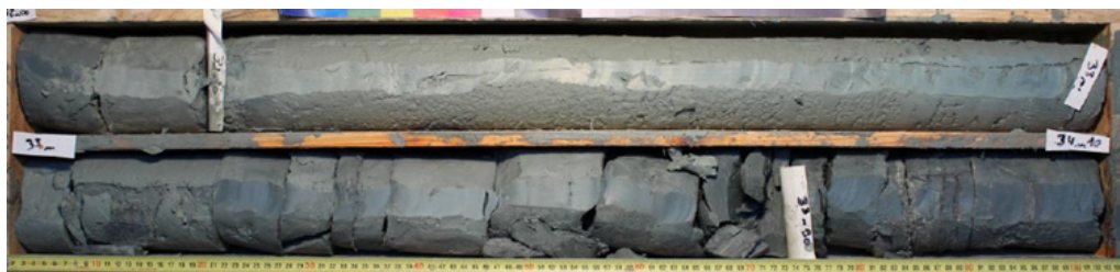
L18_ANT-AVP-SC02603_Marnes grises légèrement bleutées, homogènes (Marnes d'Argenteuil)
