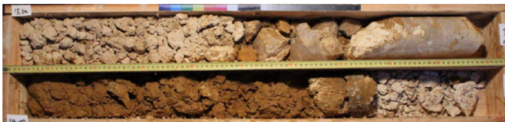
L18_GUY-AVP-SC03111_Passée de 40 cm de meulière siliceuse (non vacuolaire) en haut à droite, dans marnes et argiles résiduelles "déstructurées"
