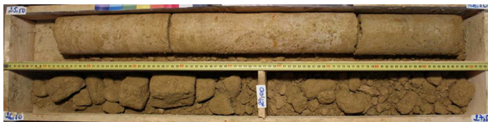
L15O_STC-AVP-SC01349_Calcaire massif et calcaire altéré désagrégé
