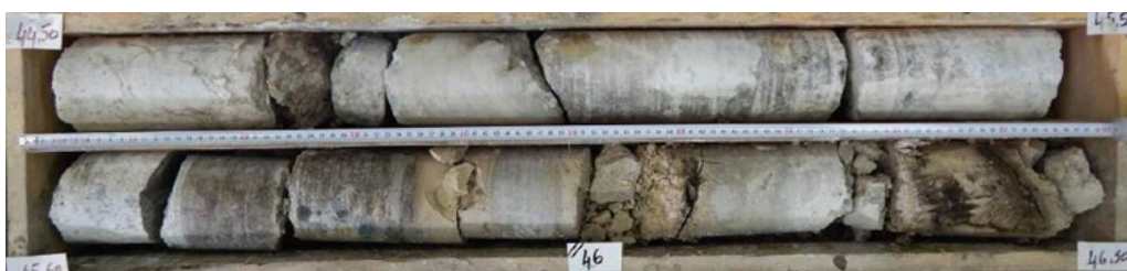
L16_SEV-AVP-SC2173_Gypse massif "albastroïde" (et intercalations carbonatées beiges peu épaisses) au sein des Marnes et Caillasses
