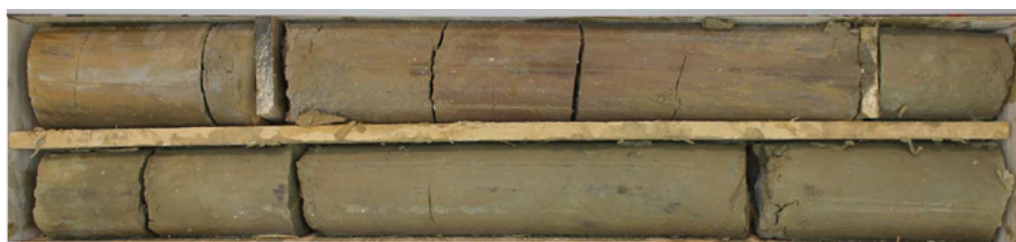
L15E_RSB-AVP-SC4290_Alluvions modernes argileuses très compactes
