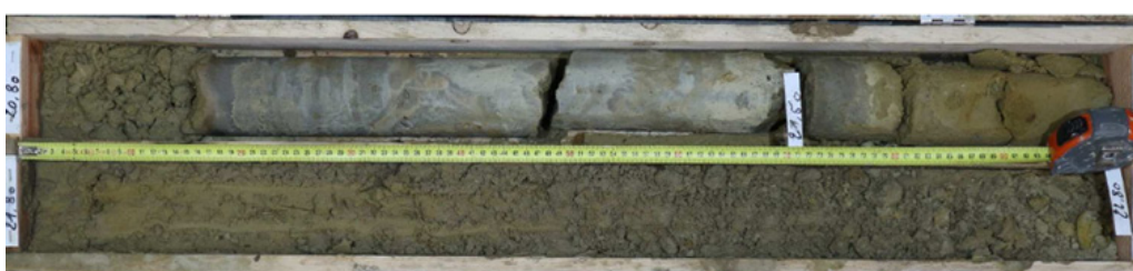
L17_GON-AVP-SC1704_Banc dur calcaire et/ou siliceux intercalé dans du sable meuble
