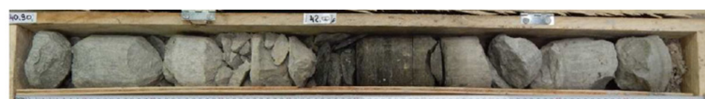
L16_CLI-AVP-SC0889_Intercalation d'argile sombre dans calcaire clair
