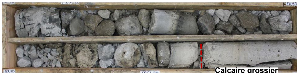
L15E_RSB-AVP-SC4203_Faciès basal rocheux fragmenté sur Calcaire grossier massif
