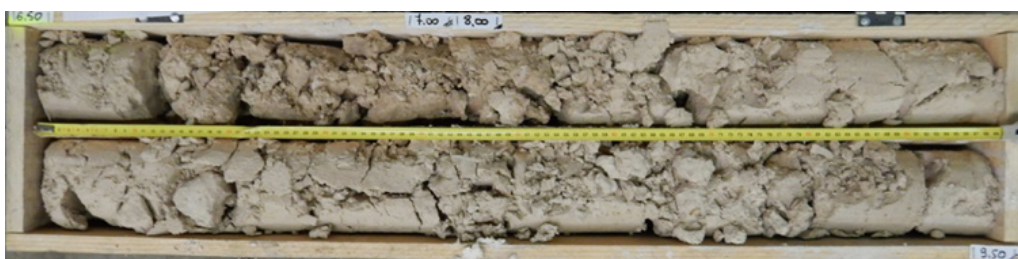
L17_TEF-AVP-SC3851_Calcaire altéré friable en partie désagrégé
