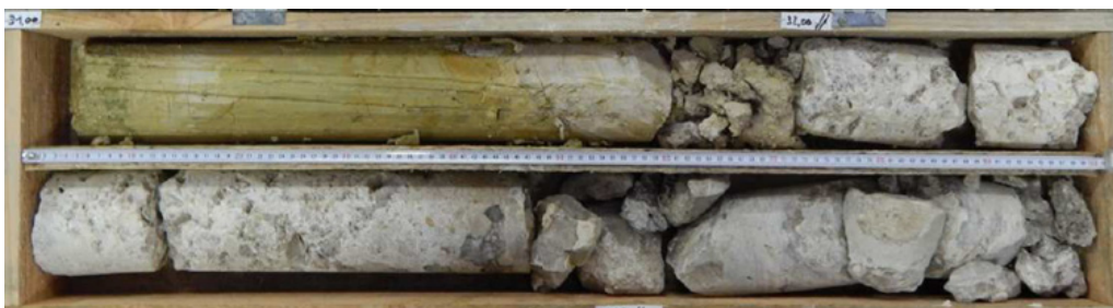
L16_CSM-PRO-SC332_Calcaire tendre vert kaki et calcaire franc, dur et vacuolaire
