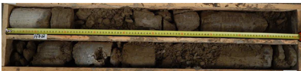
L16_CHL-AVP-SC2085_Faciès calcaire altéré de profondeur observé dans le secteur de Chelles, sous la vallée de la Marne
