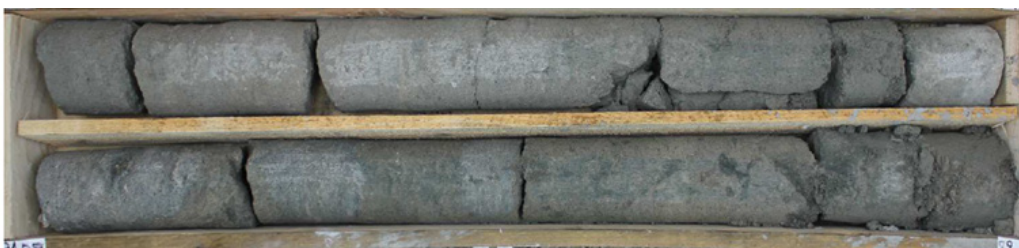
L15E_RSB-AVP-SC04290_Calcaire grossier inférieur gris-vert glauconieux
