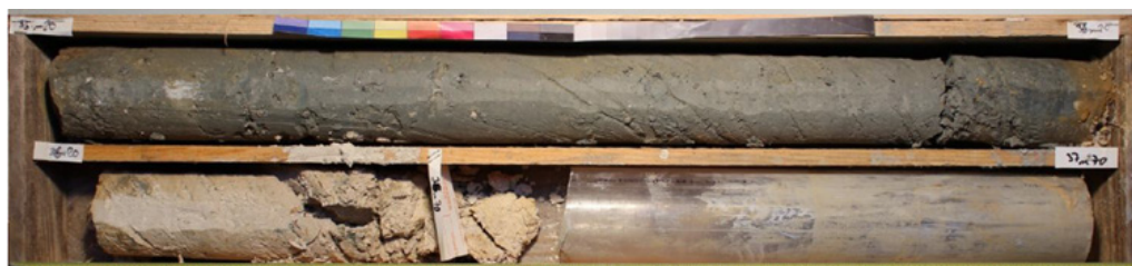
L18_PAL-AVP-SC02248_Faciès profond marno-argileux pas ou peu altéré
