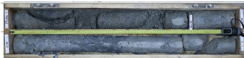
L16_CHL-PRO-SC5595_Calcaire inférieur glauconieux friable sur argile grise de l'Yprésien (= Argile au sommet des Sables supérieurs ou Argile plastique directement sous le Calcaire grossier ?)
