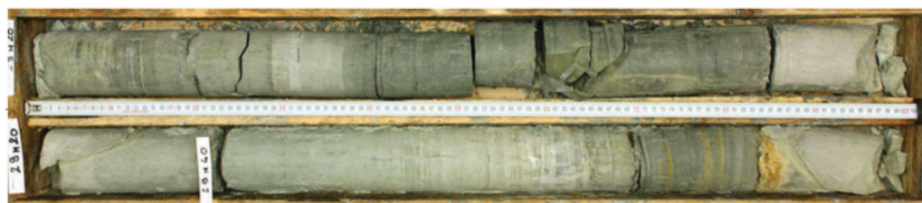
L15S_CAC-AVP-SC1846_Alternance d'horizons sombres et clairs dans les Marnes bleues d'Argenteuil
