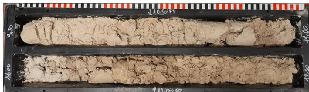
L15NE_SC8805_Calcaire beige-brun très fortement altéré et désagrégé en caisse (calcaire initialement tendre)
