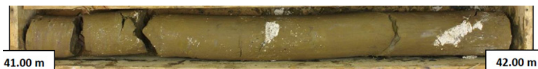
L14S_PAR-PRO-SC3057_Faciès atypique kaki de la formation de l'Argile plastique, avec nodules de calcaire blanc-beige, typiques des "Marnes à rognons"
