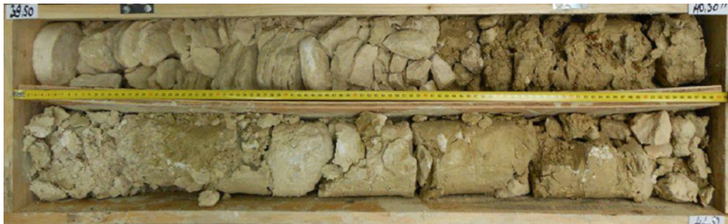
L16_CHL-AVP-SC0893_Gypse semi rocheux très fragmenté (en haut à gauche), et marnes tendre "déstructurées"
