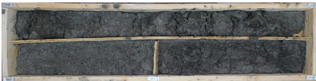
L15E_AUB-AVP-SC4056_Sables gris verdâtre pouvant être interprétés comme des Sables de Cuise (glauconieux) au sens propre
