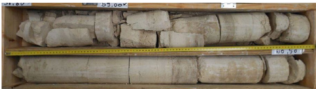
L16_LIG-AVP-SC2082_Calcaire semi-rocheux "profond" non altéré. Fracturation verticale
