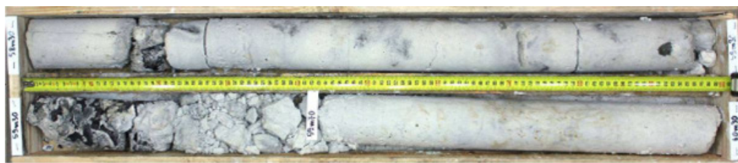
L15S_CHA-AVP-SC2337. Craie globalement massive à niveaux de silex noirs
