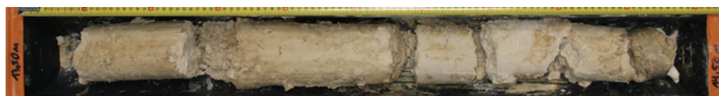
L15S_SC18_Faciès carbonaté des Marnes et Caillasses très tendre et altéré (en position superficielle) mais peu déstructuré
