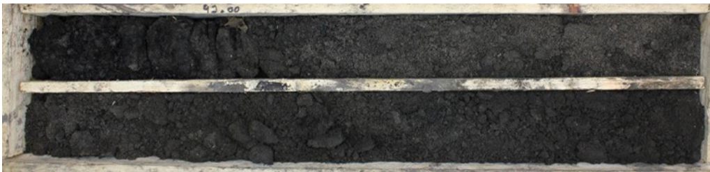
L15E_CHA-AVP-SC4268_Sable gris-noir un peu ligniteux (Sables supérieurs)
