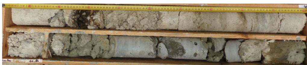
L16_LCO-EXE-SC06331_Banc de calcaire dur vraisemblablement dolomitique et probablement silicifié (carotte du bas) dans calcaire (marneux ?) tendre et friable
