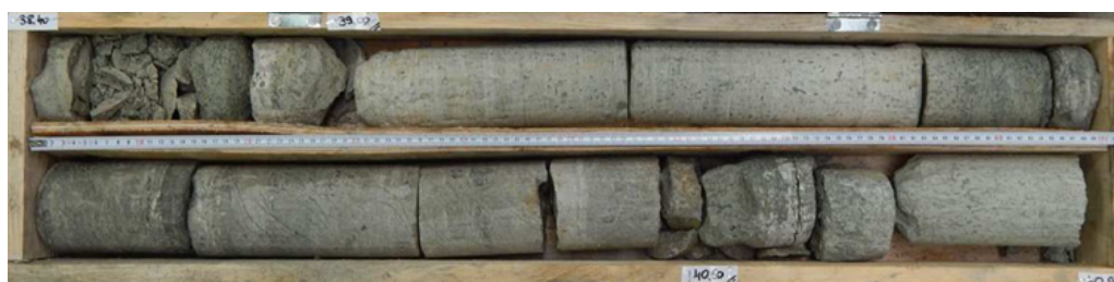
L16_CLI-AVP-SC0889. Faciès carbonaté à taches (de gypse ?)
