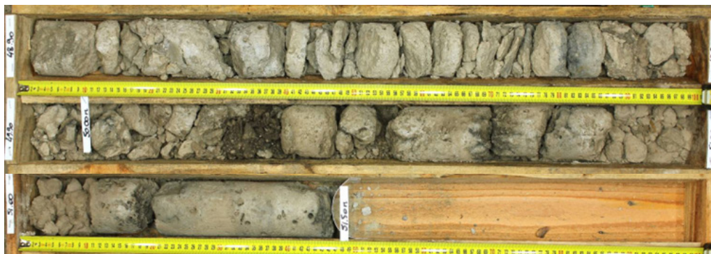
L15S_CAC-AVP-SC02349_Calcaire fin à finement gréseux, plus ou moins lité et dur présentant des empreintes de gastéropodes (= Calcaire montien ?), ici de 2,5 m minimum d'épaisseur
