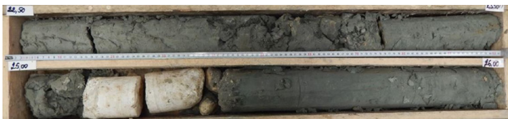
L16_STD-AVP-SC2071_Intercalation de gypse albâtre dans les Sables de Beauchamp. Observation rare et localisée
