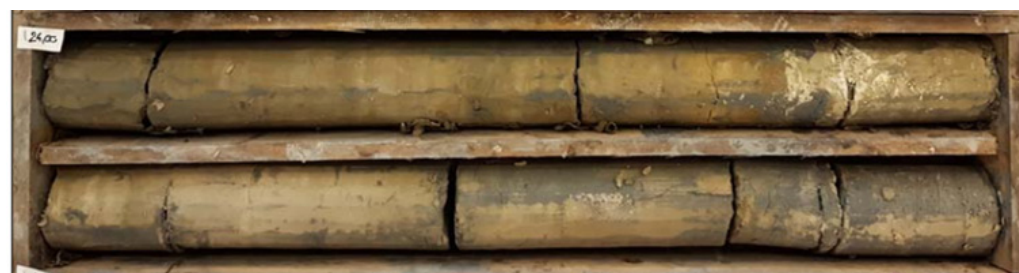
15S_Gare Noisy-le-Champs. Faciès beige-ocre "décolorée" de la partie inférieure des Marnes bleues
