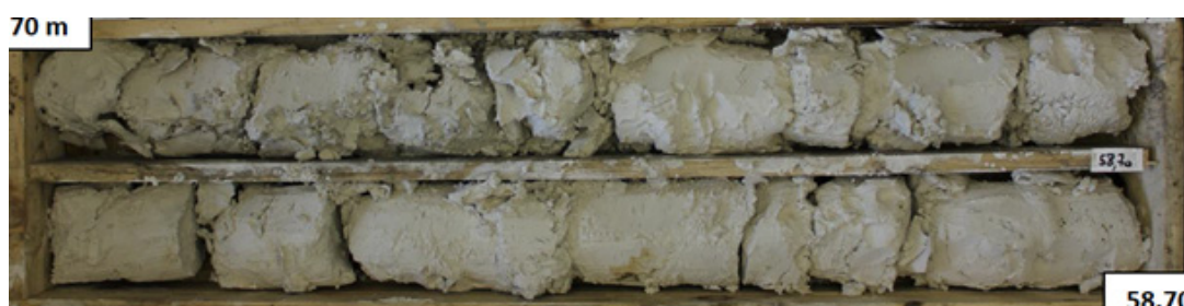
L15S_MAL-AVP-SC1010. Craie franchement altérée et meuble
