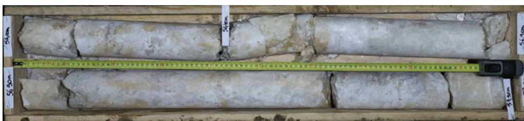
L16_CHL-EXE-SC5608_Gypse massif "albastroïde" dans les Marnes et Caillasses
