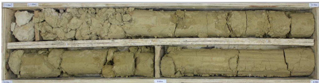
L15E_CHA-AVP-SC04282_Sable fin de teinte beige-kaki (teinte observée sur toute l'épaisseur de la formation dans ce sondage)
