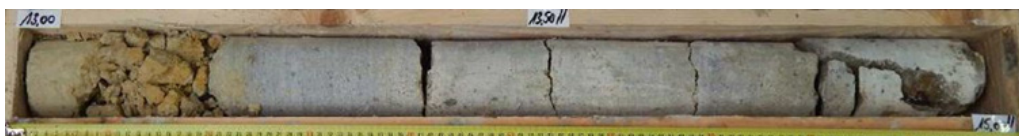
L16_AUL-AVP-SC2071_Banc presque métrique de calcaire dur au sein des Sables de Beauchamp
