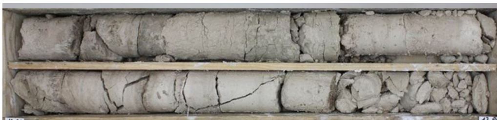
L15E_BON-AVP-SC4173_Calcaire ou calcaire marneux tendre à très tendre, modérément altéré
