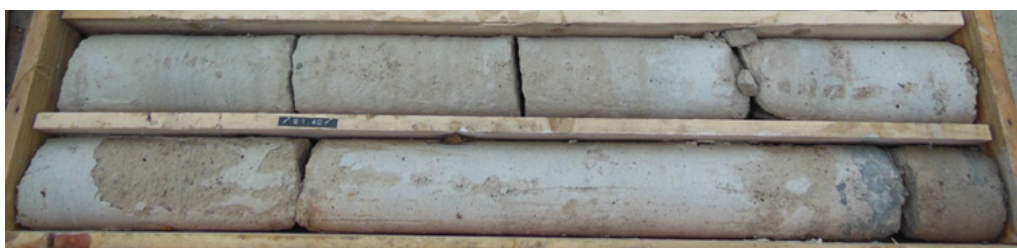
EOLE_SC7230_Faciès calcaire rocheux assez homogène
