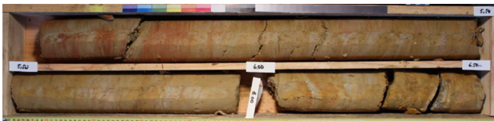
L18_MLH-AVP-SC02578_Faciès bariolé (similaire à celui de l'Argile plastique) de la formation des Meulières de Montmorency
