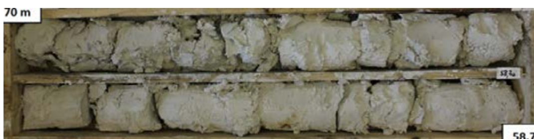
L15S_MAL-AVP-SC1010. Craie franchement altérée et meuble
