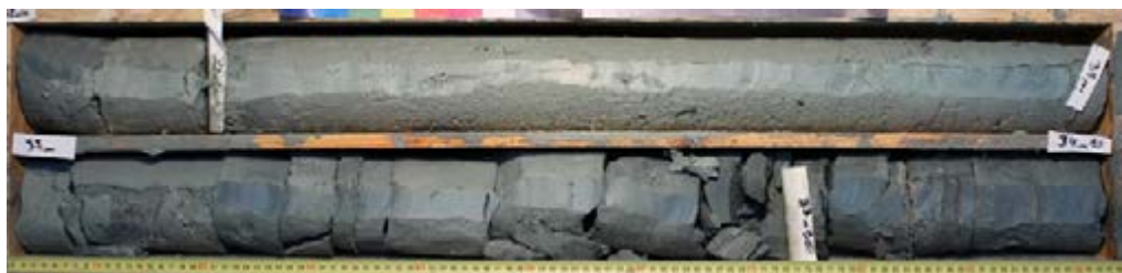
L18_ANT-AVP-SC02603_Marnes grises légèrement bleutées, homogènes (Marnes d'Argenteuil)
