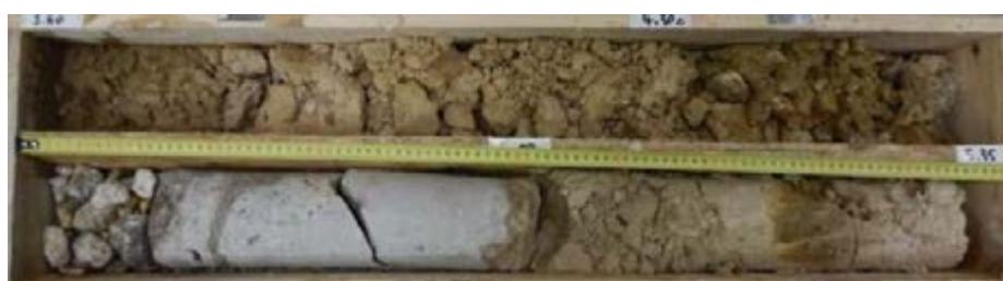
L16_MOF-PRO-SC3314_Banc de calcaire dur (± meulière siliceuse) et marnes/argiles altérées résiduelles "déstructurées"
