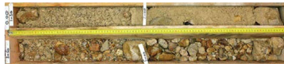
L15S_CHA-FAI-SC0111_Alluvions anciennes très sableuses puis très graveleuses (silex beige-brun)
