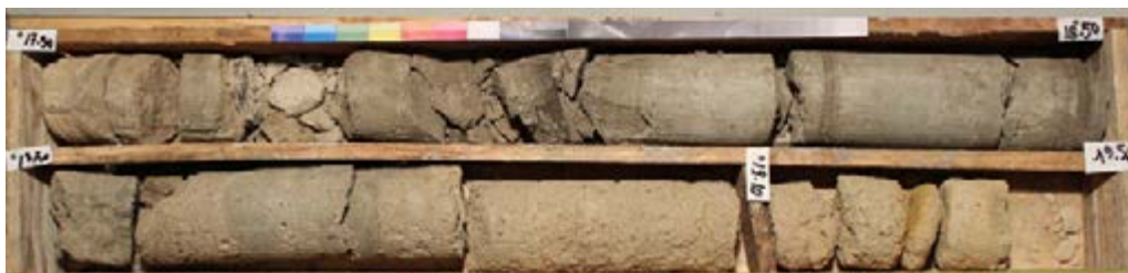
EOLE_SC-SUP-5540_Banc grisâtre pluridécimétrique (carotte du haut) = Banc vert très probable
