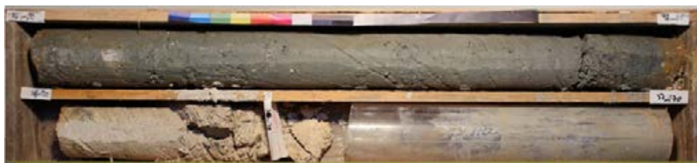
L18_PAL-AVP-SC02248_Faciès profond marno-argileux pas ou peu altéré
