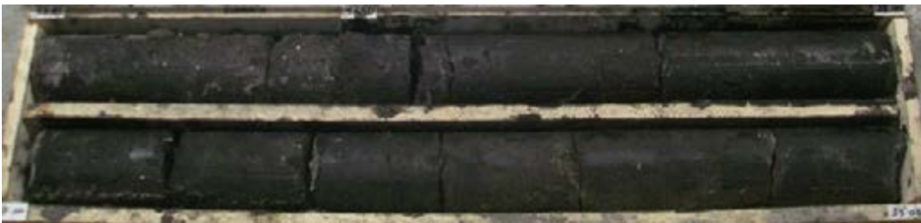
EOLE_PRO-SC-2358_Passée plurimétrique noire argileuse et ligniteuse ici en position supérieure (et ainsi intégrée dans les Sables supérieurs)
