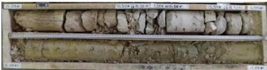
L17_AVL-AVP-SC2836_Banc de calcaire fragmenté de Ducs, dur et d'épaisseur pluridécimétrique (en haut à droite)
