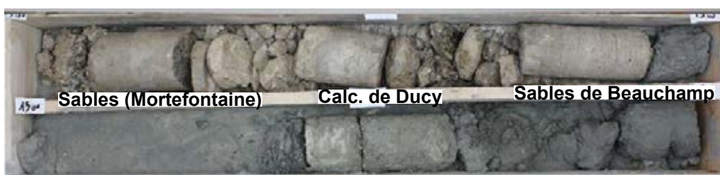
L15E_BOB-AVP-SC4111_Succession Calcaire et sables de Mortefontaine - Banc calcaire de Ducy à la base du Calcaire de Saint-Ouen
