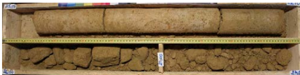
L15O_STC-AVP-SC01349_Calcaire massif et calcaire altéré désagrégé
