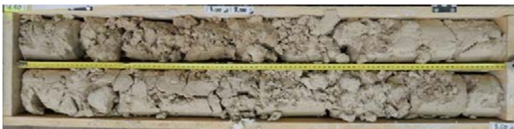
L17_TEF-AVP-SC3851_Calcaire altéré friable en partie désagrégé
