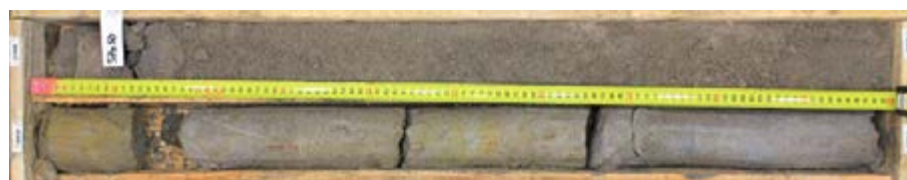
L15E_CHA-PRO-SC2702_Passée de sable franc meuble et argiles légèrement bariolées. La présence de sable franc dans l'Argile plastique est observée principalement dans le Sud de Paris (ligne 15 Sud)
