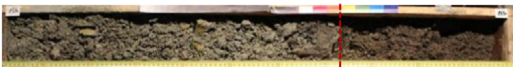
EOLE_PRO-SC-5550_Base du Calcaire grossier très désagrégée à sableuse (à gauche du trait repère) interprétée comme l'horizon de "Glauconie grossière" au-dessus des Sables supérieurs de l'Yprésien (à droite)
