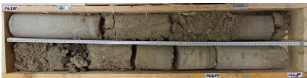
L16_CHL-AVP-SC2197_Alternance de Calcaire dur gris clair de calcaire tendre gris-marron et d'un faciès altéré sableux
