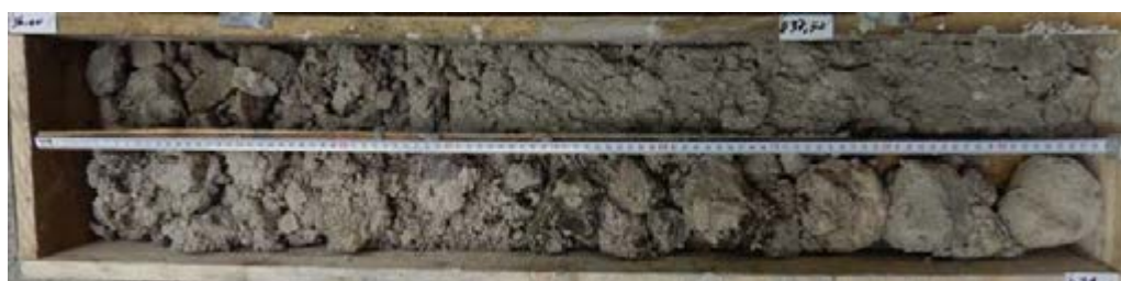
L16_CHL-AVP-SC2197_Faciès complètement altéré et déstructuré/désagrégé dans les Marnes et Caillasses (gypse initialement présent et complètement dissout ?)
