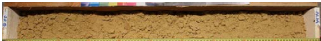
L15O_SC04970_Faciès oxydé (altéré) des Sables supérieurs en position superficielle
