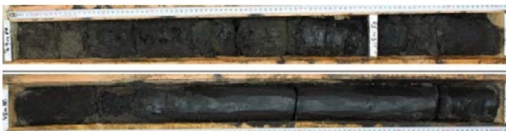
L15S_CHA-AVP-SC0828_Sable et argile noirs en alternance, typique de l'horizon des Fausses Glaises
