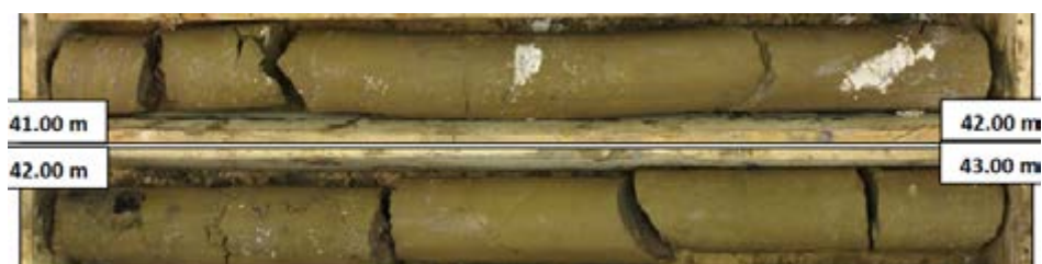
L14S_PAR-PRO-SC3057_Faciès atypique kaki de la formation de l'Argile plastique, avec nodules de calcaire blanc-beige
