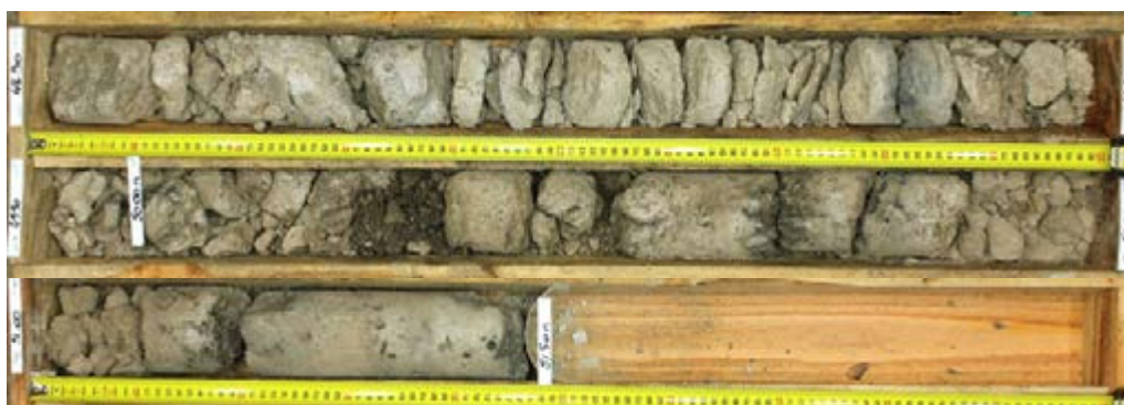
L15S_CAC-AVP-SC02349_Calcaire fin à finement gréseux, plus ou moins lité et dur présentant des empreintes de gastéropodes (= Calcaire montien ?), ici de 2,5 m minimum d'épaisseur
