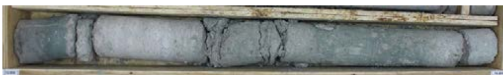
L15E_AUB_AVP_SC04077_Calcaire grossier inférieur à passées tendres vertes très glauconieuses (glauconie diffuse) séparées par du calcaire peu ou pas glauconieux
