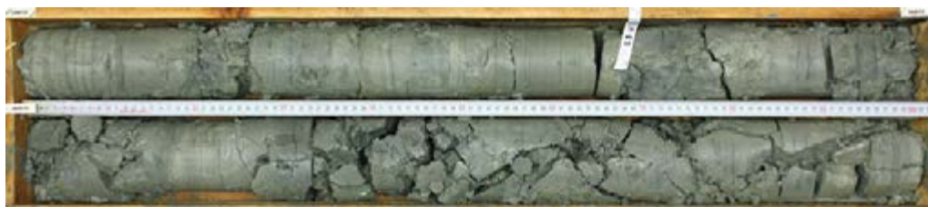
L16_CSM-AVP-SC0812_Marnes gris-verdâtre à litage fin net. Quelques fractures "obliques" franches (Marnes d'Argenteuil)
