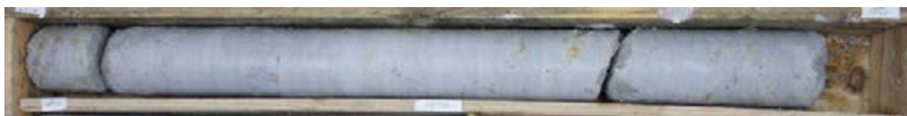
L15O_NAN-PRO-SC04980_Calcaire fin et dur de la partie inférieure des Marnes de Meudon (= Calcaire montien), ici de 4,5 m minimum d'épaisseur
