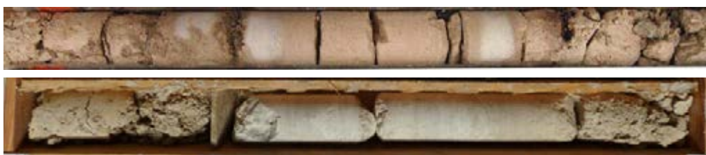
L15E_NSM-FAI-SC4713 et L16_LCO-EXE-SC06331_Bancs calcaires "durs" pluridimensionnels bien individualisés et calcaire tendre ou marnes
