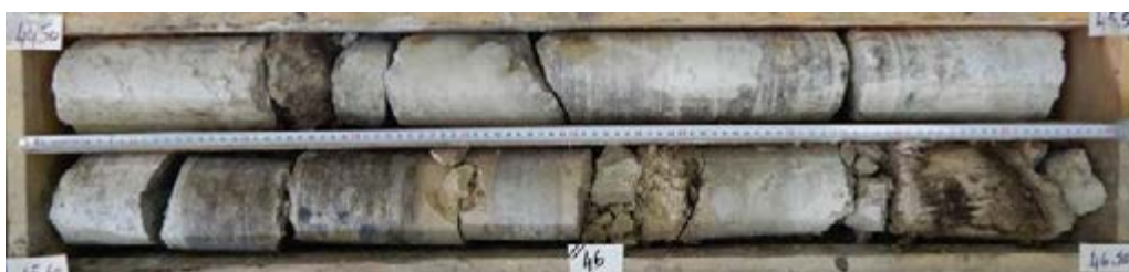
L16_SEV-AVP-SC2173_Gypse massif "alabastrine" (et intercalations carbonatées beiges peu épaisses) au sein des Marnes et Caillasses
