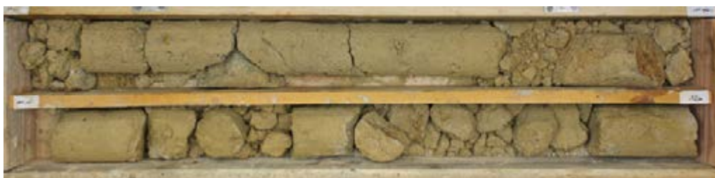
L14S_PAR-AVP-SC1292bis_Faciès calcaire altéré tendre et friable, en position superficielle
