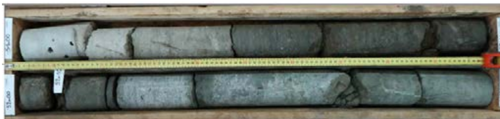
L16_CHL-PRO-SC7140_Alternance de calcaire fin, dur et clair, de marne (?) sombre et de calcaire gris-vert glauconieux
