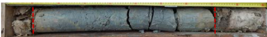
L16_CSM-AVP-SC1126_Faciès marneux à marno-sableux gris bleuté rapporté aux Sables verts
