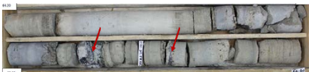
L15E_FSB-AVP-SC04302_Calcaire à intercalations fines de silex sombre (flèches rouges). Tiers supérieur de la formation (Calcaire grossier "supérieur")
