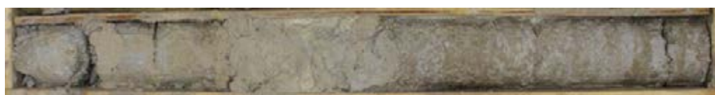
L15S_CHA-AVP-SC1907_Passée sableuse dans les marnes de Meudon, à rapporter à la formation des "Marnes à rognons"
