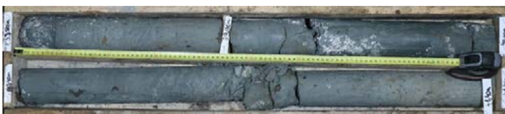
L16_CHL-EXE-SC05608_Faciès argileux compact à inclusions éparées de gypse blanc
