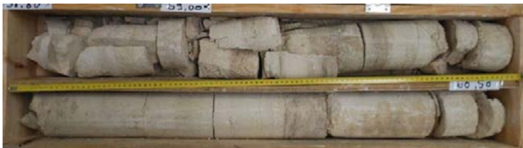
L16_LIG-AVP-SC2082_Calcaire semi-rocheux "profond" non altéré. Fracturation verticale
