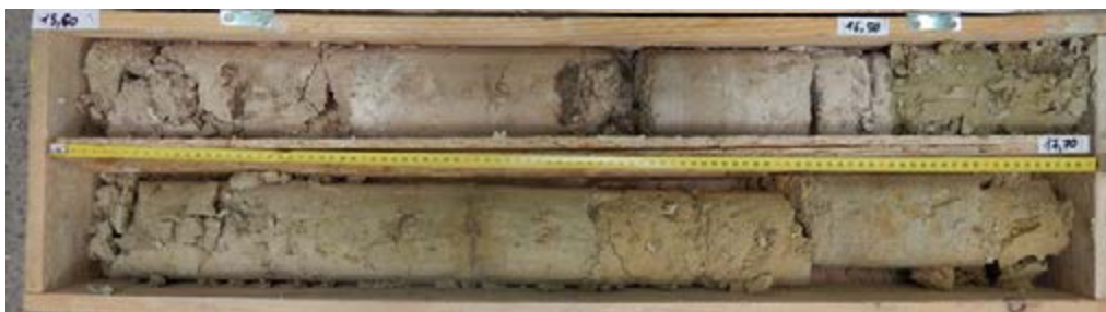
L17_VLP-AVP-AC3785_Banc de calcaire de Ducs bien développé d'épaisseur pluridécimétrique (carotte du haut)
