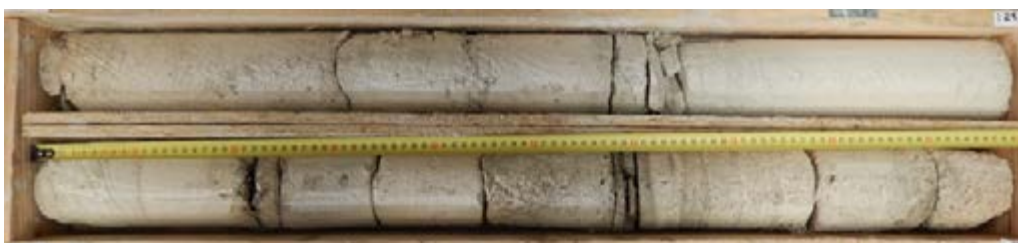
L17 VLP-AVP-SC3712_Faciès courant ou "standard" des calcaires de la formation des Marnes et Caillasses : calcaire beige semi-rocheux ("tendre") peu altéré assez homogène (quelques lits argileux fins)
