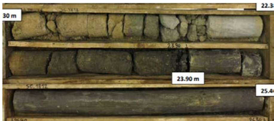
L15S_CAC-AVP-SC01812_Faciès argileux gris-marron vraisemblablement pyriteux, atypique directement sous la Calcaire grossier (altéré) et rapporté à l'Argile plastique
