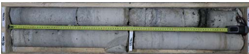
L16_CHL-EXE-SC5608_Calcaire (dolomitique ?) massif des Marnes et Caillasses, intercalation marneuse sombre pluricentimétrique
