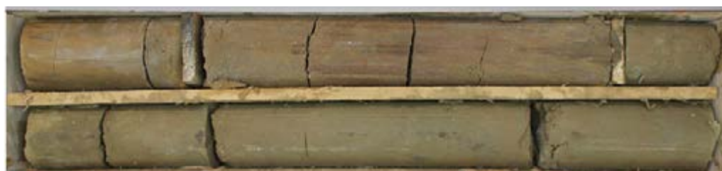
L15E_RSB-AVP-SC4290_Alluvions modernes argileuses très compactes
