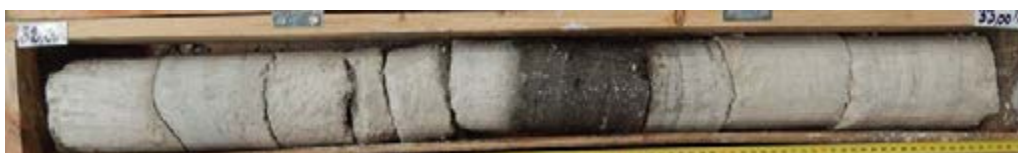
L16 AUB-AVP-SC1497_Intercalation argileuse sombre décimétrique dans calcaire tendre "semi-rocheux"
