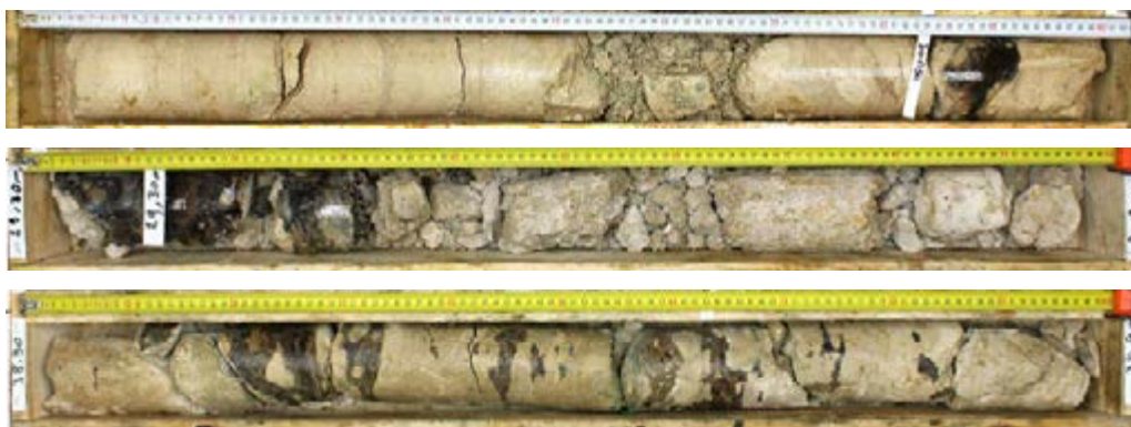
De haut en bas : L16_NLG-AVP-SC0906, L16_CSM-FAI-SC0081 et L16_CSM-FAI-SC0075_Calcaire principalement tendre (localement plus dur) contenant des silex bruns de forme très irrégulière, isolés ou "anastomosés"
