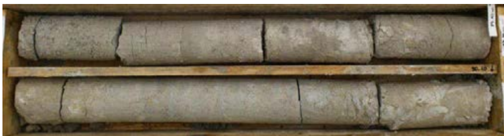
L15E_BON-FAI-SC4678(SC0054) _Faciès carbonaté homogène et tendre un peu altéré
