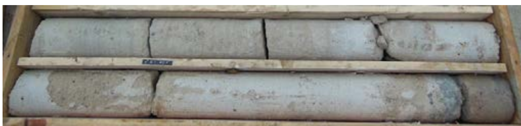
EOLE_SC7230_Faciès calcaire rocheux assez homogène
