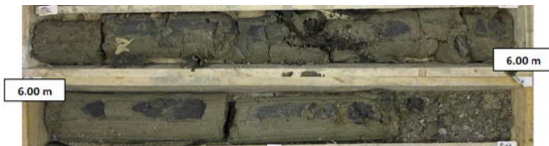
L15W_ISS-FAI-SC0227_Alluvions modernes essentiellement argileuses
