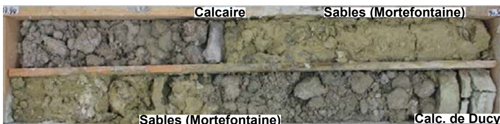
L15E_RSB-AVP-SC4203_Succession Mortefontaine - Ducy peu caractéristique avec bancs calcaires "embryonnaires". Ensemble déstructuré
