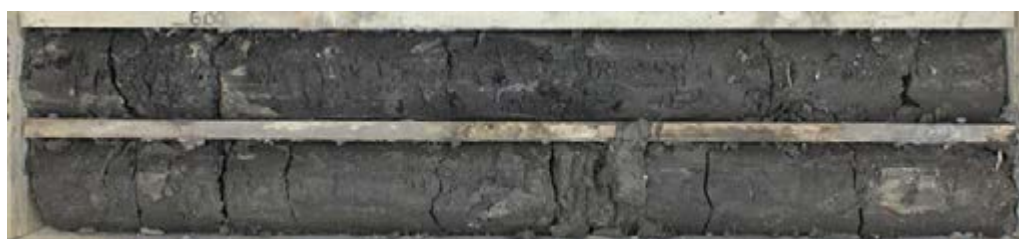
L15E_CHA-AVP-SC04268 (sous la Marne)_Alluvions modernes argileuses
