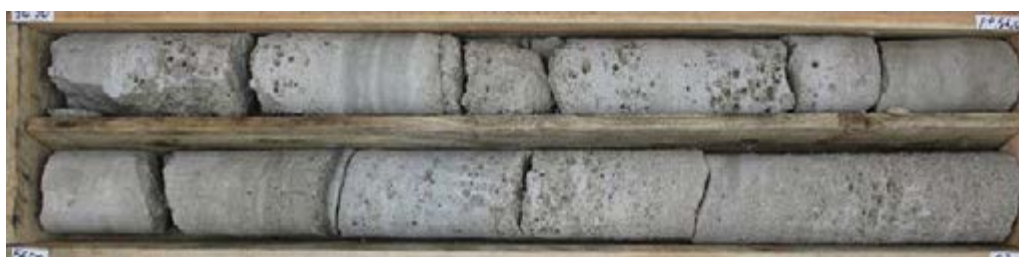
L15E_RSB-AVP-SC4203_Calcaire gris localement lité ou rubané et à passées très vacuolaires (dissolution de coquilles) régulièrement observées et définissant le caractère "grossier" du calcaire
