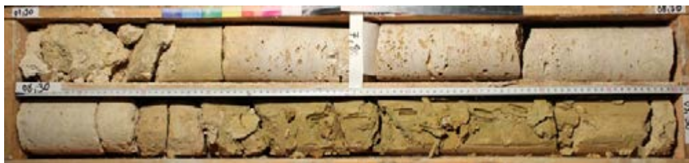
L15O_STC-AVP-SC03536_Banc de Roche sommital du Calcaire grossier sur faciès tendre marneux meuble pulvérulent très atypique
