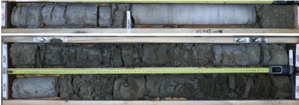
L16_CHL-PRO-SC5595_Calcaire massif et dur et sable sombre atypique (possiblement à glauconie abondante et altérée)
