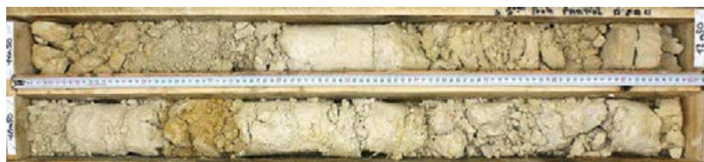
L15S_CHA-AVP-SC0828_Faciès très altéré et très déstructuré des Marnes et Caillasses en position superficielle
