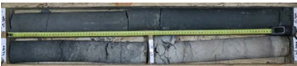
L16_CHL-EXE-SC05608_Passage légèrement progressif d'un faciès argilo-sableux des Sables de Beauchamp) aux Marnes et Caillasses (avec remaniement probable)
