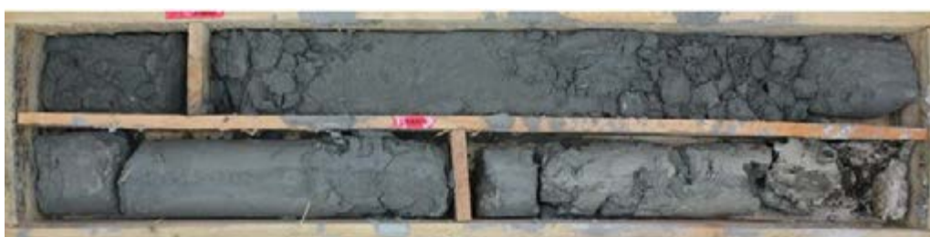
L15E_PAN-AVP-SC4087_Sable fin gris lâche (meuble) à cohérent/serré en caisse
