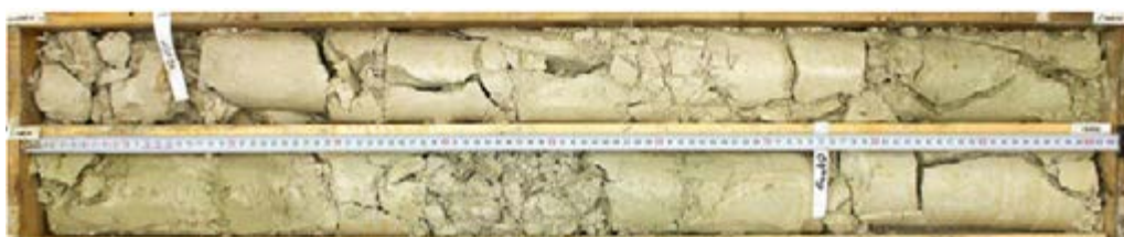
L16_NLG-AVP-SC0906_Marnes homogènes beiges
