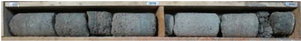
L150_NAN-PRO-SC06793_Calcaire grossier inférieure glauconieux (CGi), massif : la glauconie ici abondante et diffuse, donne la teinte verte au calcaire
