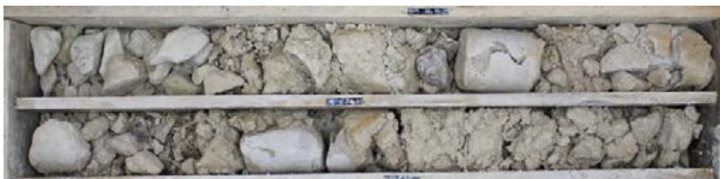
L15E_CHA-AVP-SC04281_Bancs ou fragments de calcaire dur et calcaire tendre très altéré. Ensemble déstructuré
