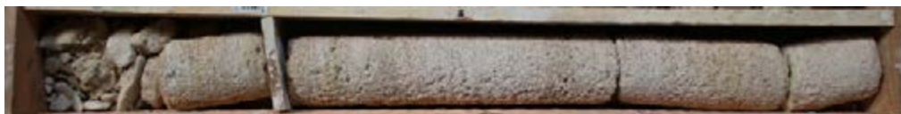
L150_NAN-PRO-SC06793_Faciès calcaire très grossier = très coquiller et vacuolaire (dissolution de coquilles)
