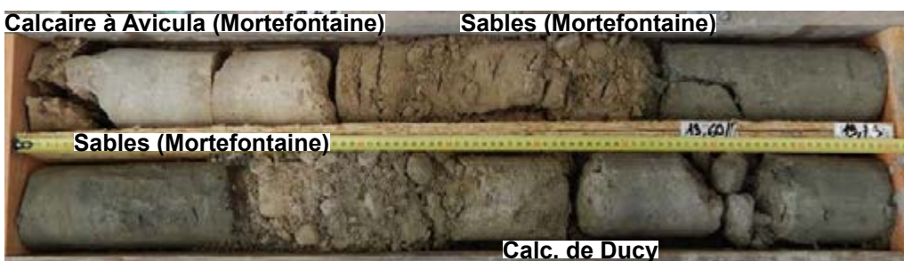
L16_BLM-AVP-SC1049. Succession Mortefontaine - Ducy bien identifiable avec bancs de calcaires franc. Passée sableuse de Mortefontaine hétérogène
