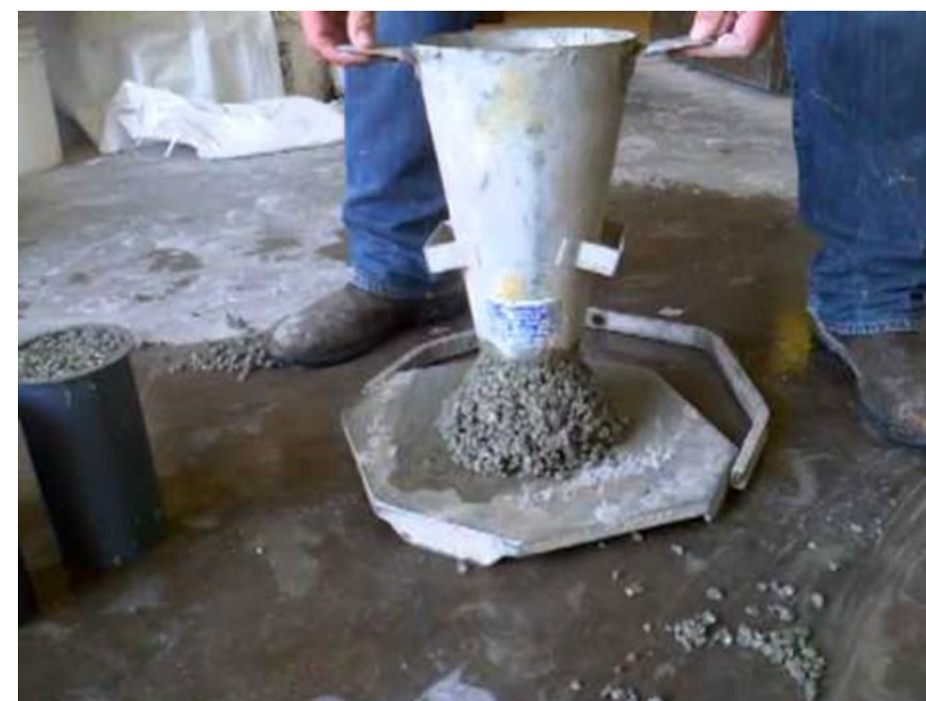
Temps d'écoulement / Flow time NF P18-469
