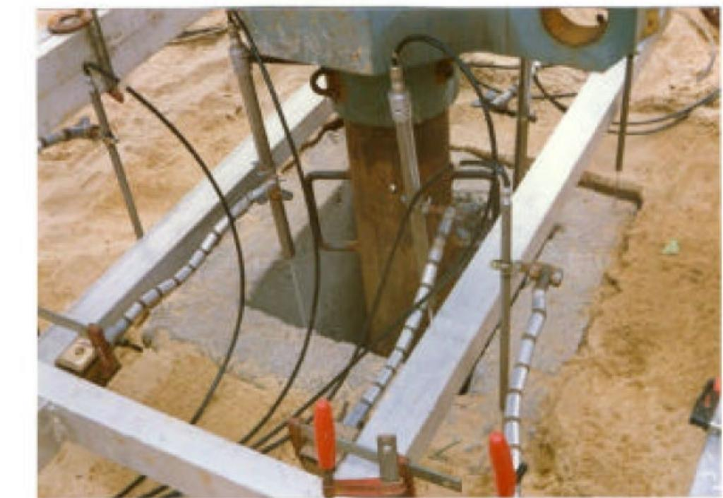
(a) - Essai de chargement de semelle coulée pleine fouille (Site de Labenne - Sable de dune)
