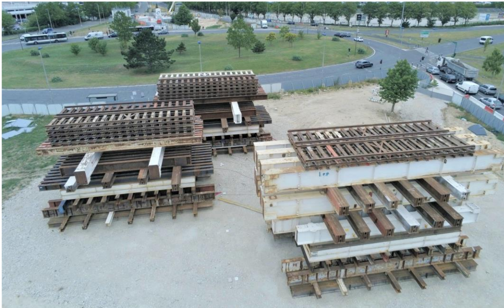
système de chargement des pieux adopté dans le projet TULIP
