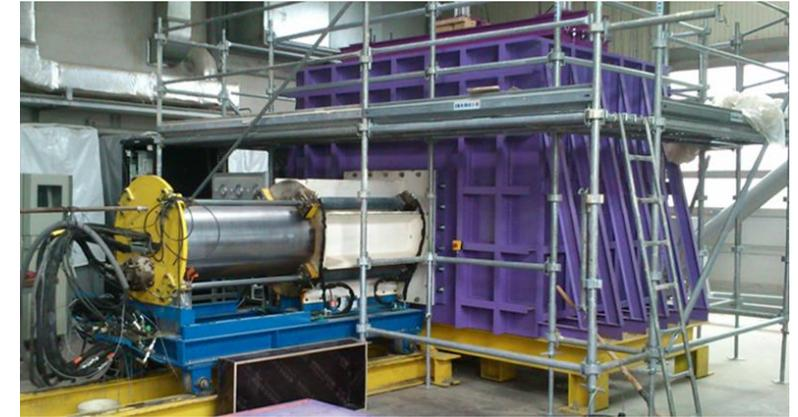
Modèle réduit de tunnelier à pression de terre de l'ENTPE (Bel, 2018)
