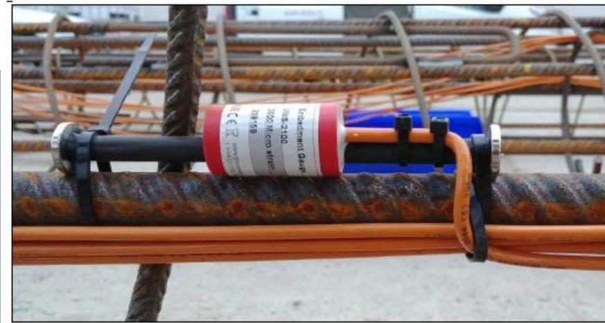
*Photographie d'un capteur à corde vibrante*
