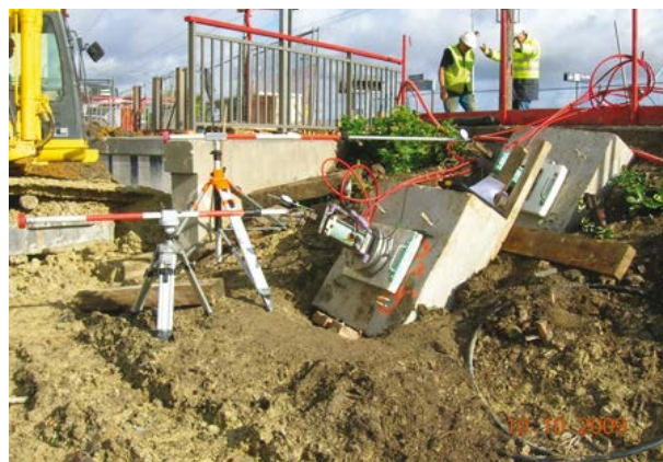
Photo 8.1a : massif de réaction en béton pour essai à la rupture préalable (© SMG)
