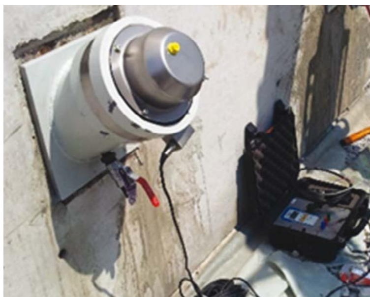
Photo 8.8 : Tête d'ancrage instrumentée avec protection de type P (© Soletanche Bachy)
