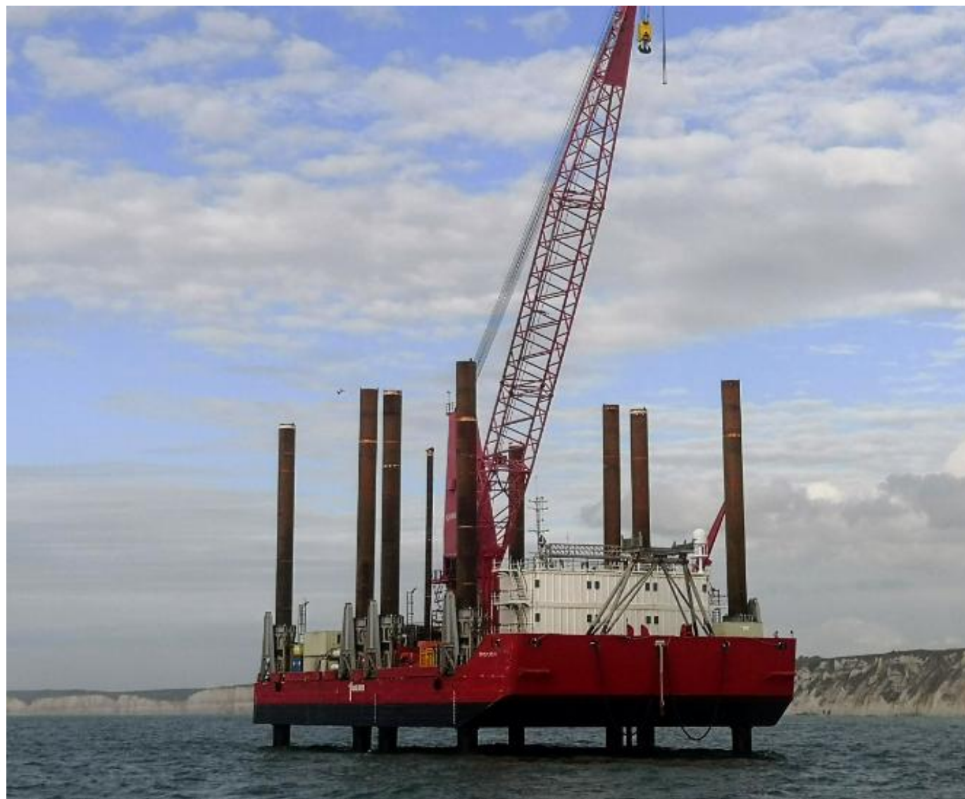
EPR2 – Sondage en mer avec diagraphies OPTV/BHTV
