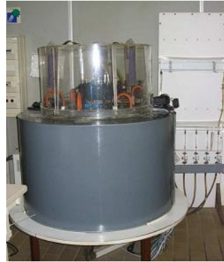
Dispositif de géligonflement NF P 98-234-2 (CEREMA Centre-Est)
