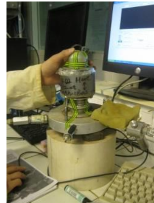
G_{max} par capteurs piézoélectriques (ENPC)
