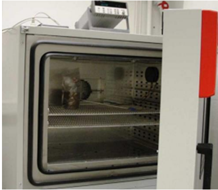
Dispositif de gélifraction prCEN/TS 13286-54 (Lhoist R&D)
