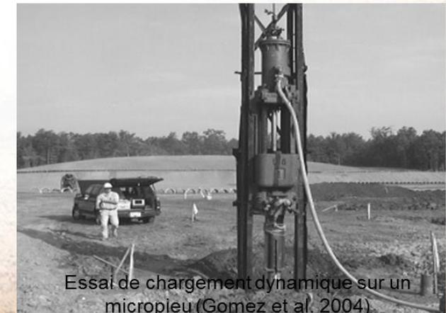
Essai de chargement dynamique sur un micropieu (Gomez et al. 2004)
