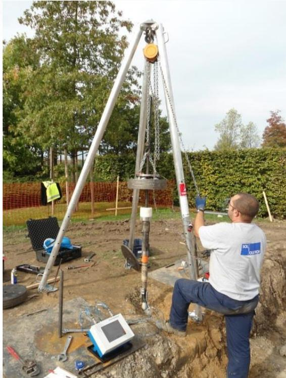
Figure : Essai Dynamique sur Micropieux
