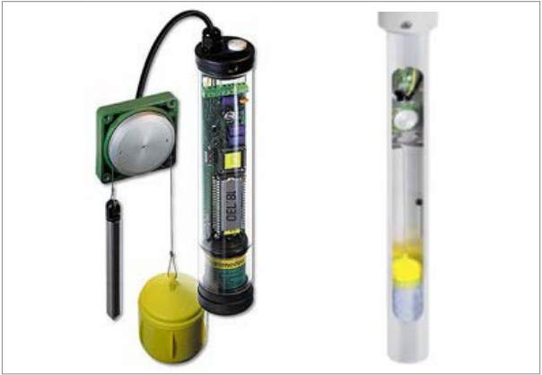
Figure 46. Exemple de capteur piézométrique à flotteur (d'après OTT - Hydrometry)
