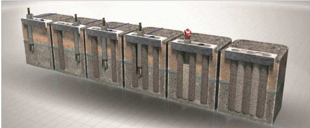
Figure 14. Séquençage de principe pour la réalisation de pieux sécants / Solétanche-Bachy
