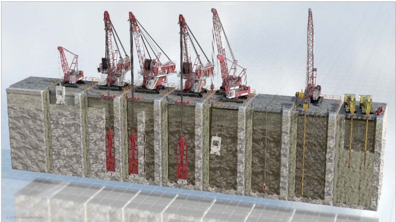
Figure 13. Séquençage de principe pour la réalisation d'une paroi moulée à l'hydrofraise / Solétanche-Bachy
