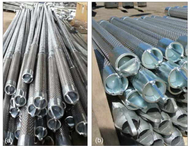
Photographie 32. Pointes filtrantes en acier galvanisé : tubes et pointes filtrantes (a) et pointes avec protection et dispositif de lancement (b)
