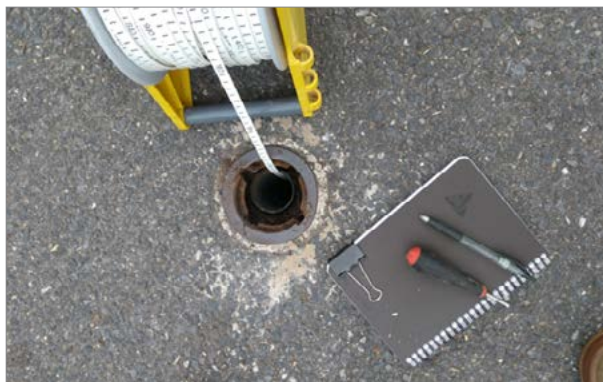
Photographie 35. Mesure manuelle de niveau d'eau dans un piézomètre
