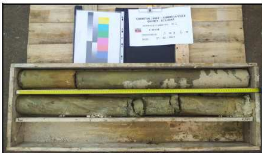
Sondage SC2 de 3.00 à 6.20m Echantillon intact de 5.00 à 6.20m
