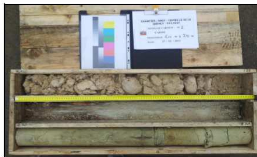
Sondage SC2 de 6.20 à 9.70m Echantillon intact de 7.50 à 8.70m
