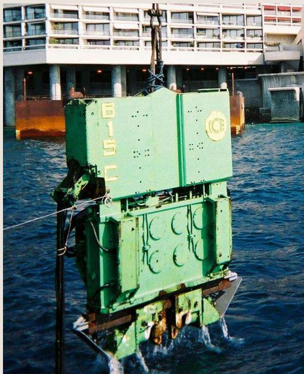
Vitesse de rotation des masses excentriques inférieure à 2000 tours par minute
