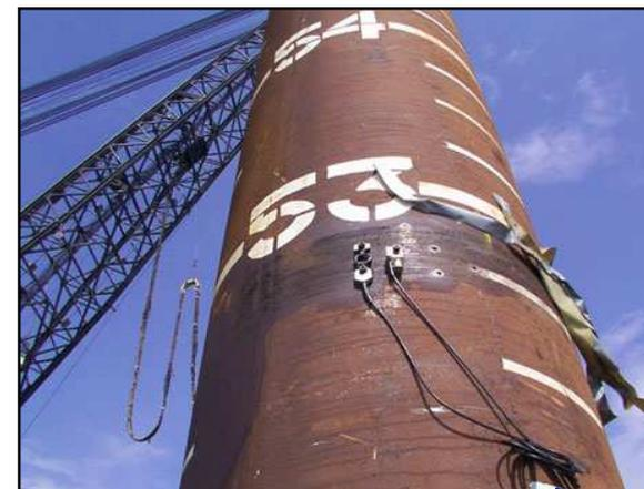
Les 4 capteurs sont connectés au système d'acquisition par un câble unique
