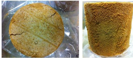
2% CaO, 7 jours de cure, après cycles gel/dégel. Éprouvette cassée avant l'essai de  $R_c$ , pas RFT
