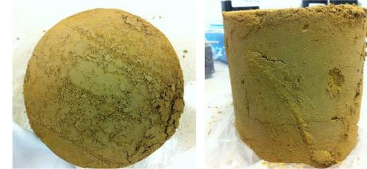
1% CaO, à 90 jours de cure, après cycles gel/dégel. Éprouvette cassée avant l'essai de  $R_c$ , pas RFT
