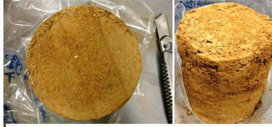
1% CaO, à 28 jours de cure, après cycles gel/dégel. Éprouvette cassée avant l'essai de  $R_c$ , pas RFT
