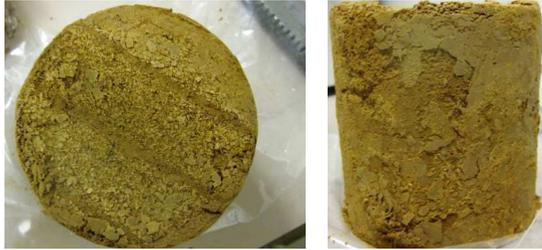
1% CaO, 7 jours de cure, après cycles gel/dégel. Éprouvette cassée avant l'essai de  $R_c$ , pas RFT
