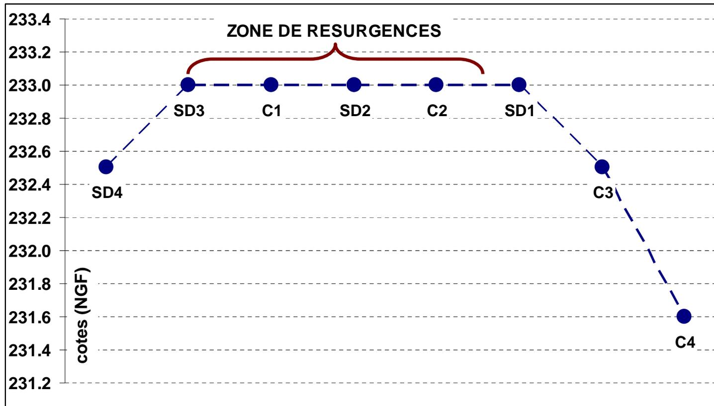
Profil en long : relevés piézométriques dans l'axe de la digue
