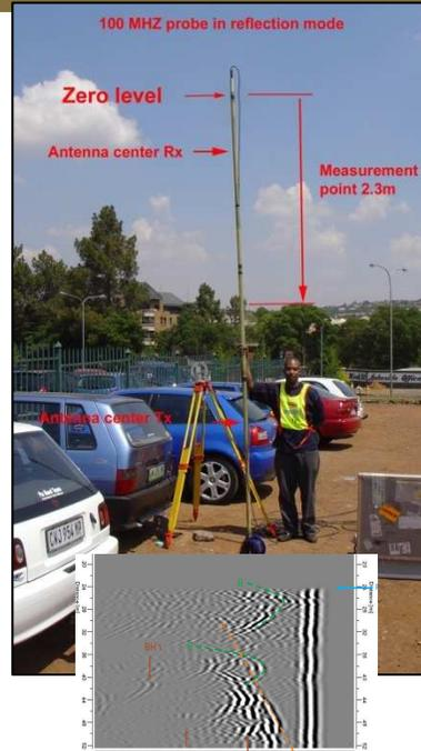
**Radar en forage pour la détection des falaises enterrées et des cavités**
