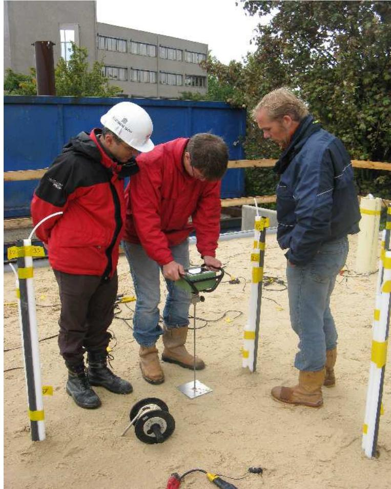
*Mesures au pénétromètre PANDA*
