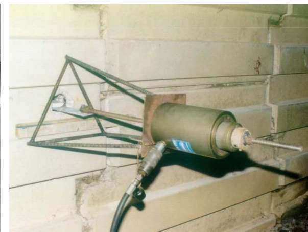
Photo 3 : Extraction du témoin avec un trépied
