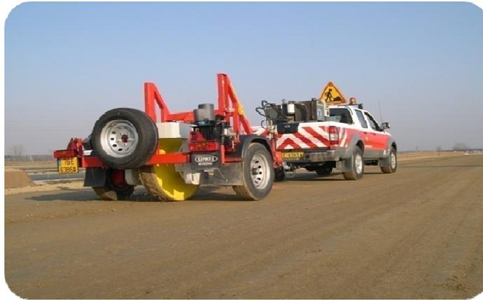
Outil développé pour le contrôle des plates formes routières et ferroviaires, utilisé en épreuve de réception ou d'information
