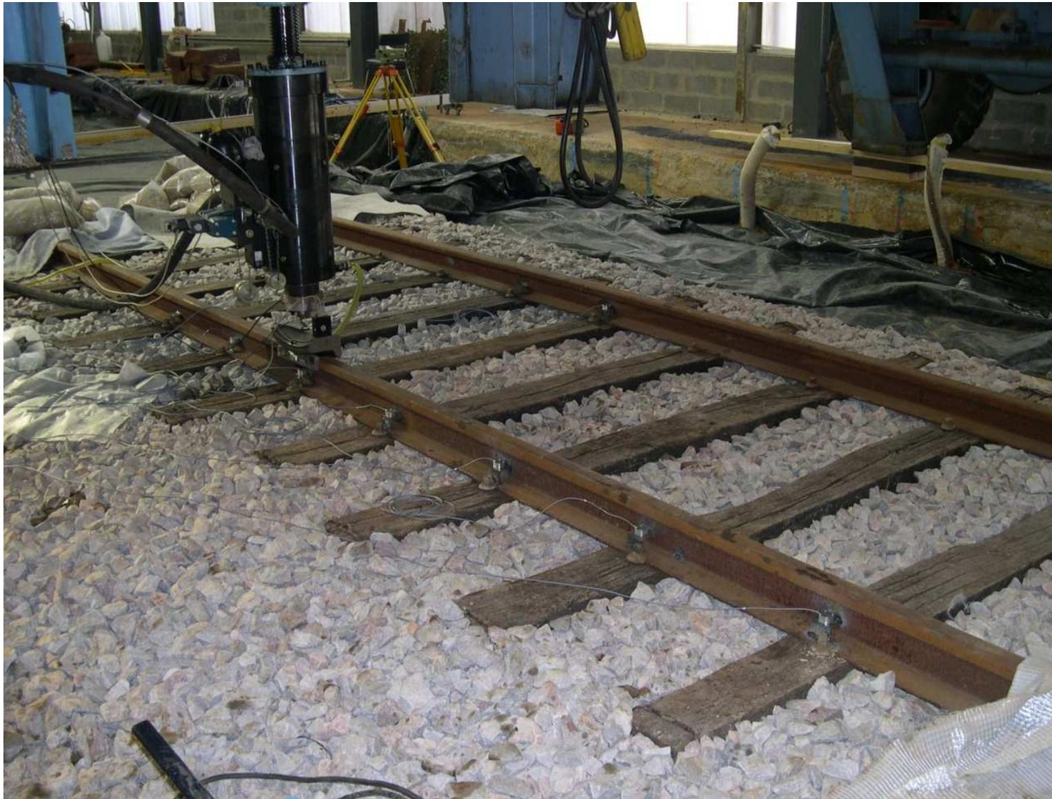
*structure expérimentale reconstituée en vraie grandeur et sollicitée dynamiquement par un vérin hydrodynamique (charge de 10 à 75 kN et fréquence de 5 à 35 Hz)*
