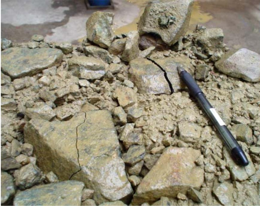
DG initiale modifiée par la rupture de particules, croissante avec la pression moyenne effective. Augmentation de la fraction de sables et de fins, moins importante, dans le squelette granulaire.
