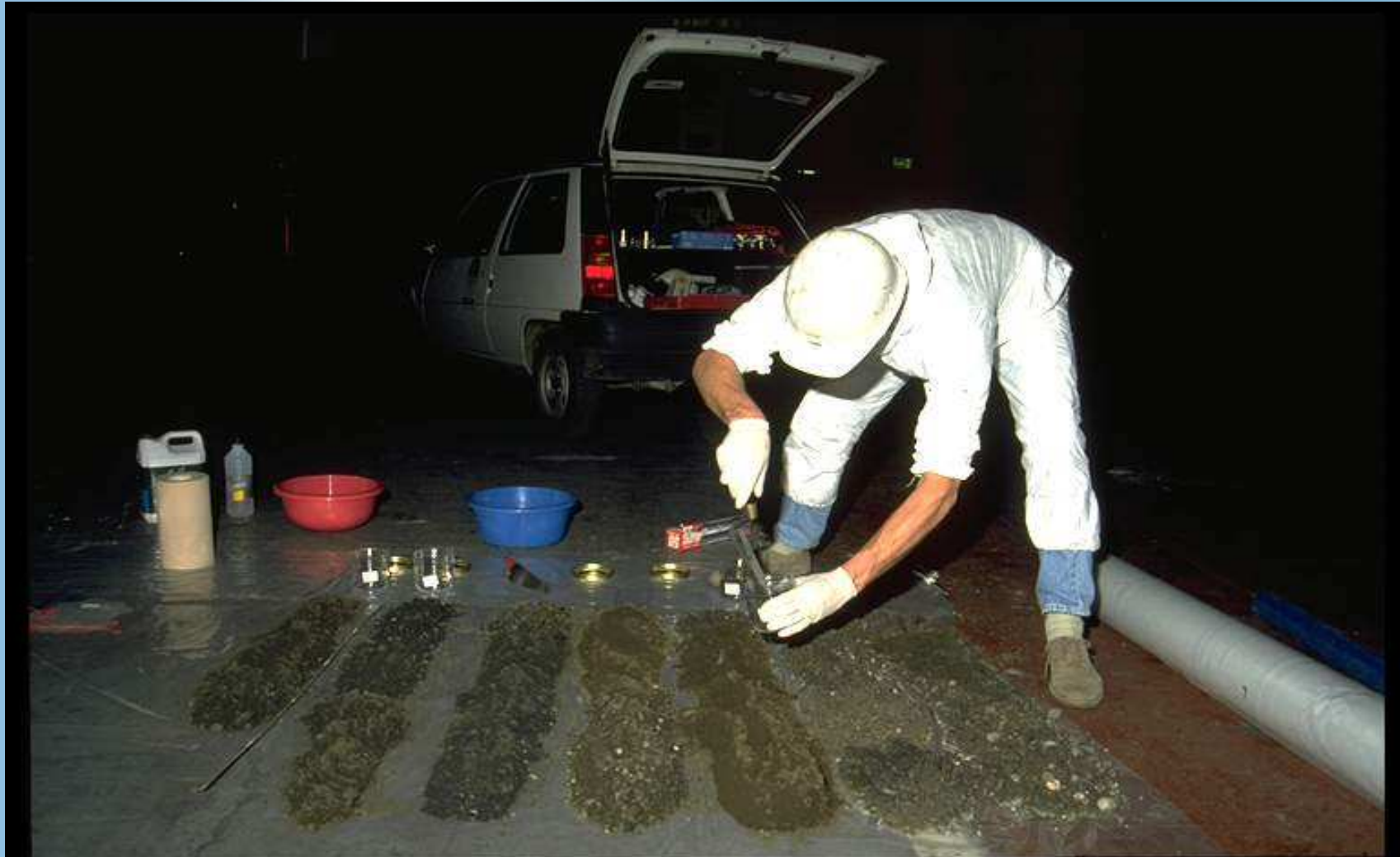
Diagnostic de sols : constitution d'échantillons moyens
