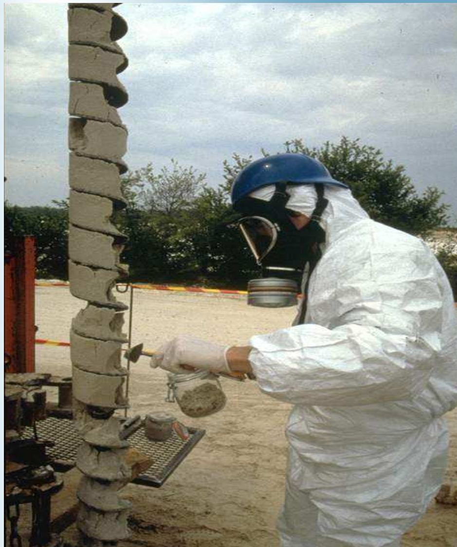
Diagnostic de sol : prélèvement d'un échantillon moyen sur une barrière
