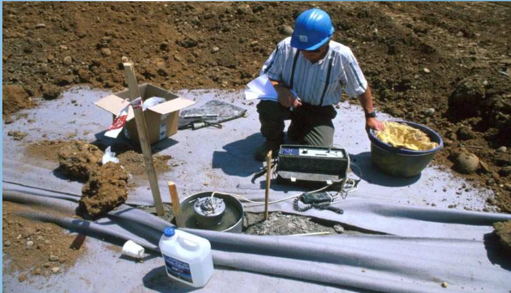
Mesure de la perméabilité à l'eau du sol superficiel
