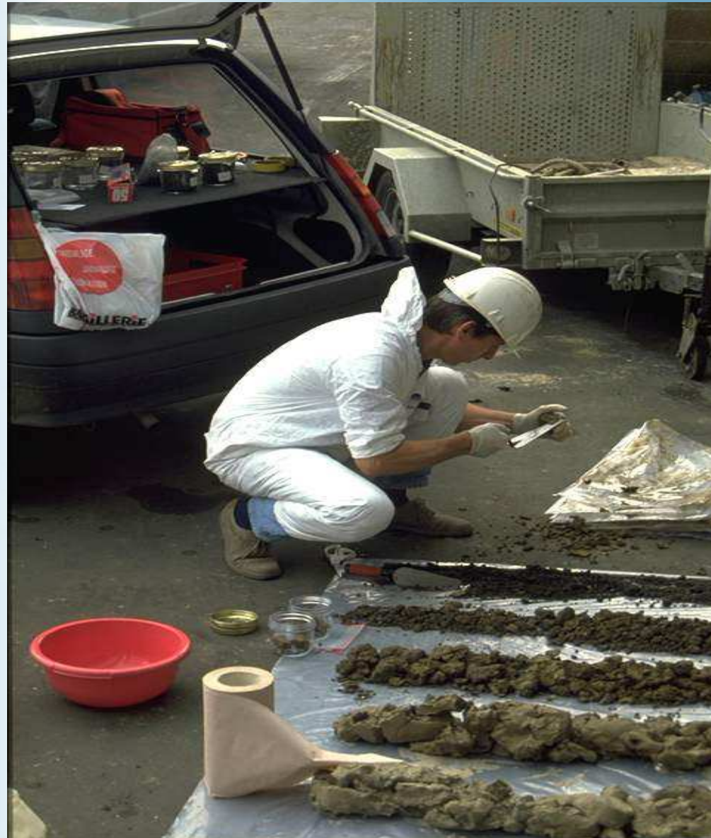
Diagnostic de sol : description des coupes géologiques
