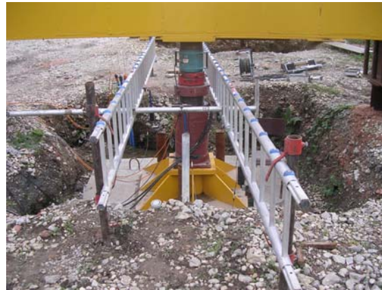
Vue en plan de l'essai de chargement sur les trois colonnes
