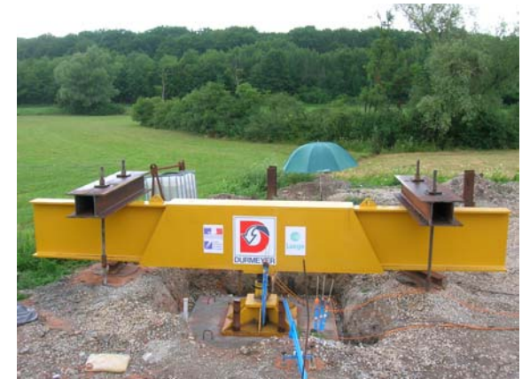
Vue en plan de l'essai de chargement sur les trois colonnes
