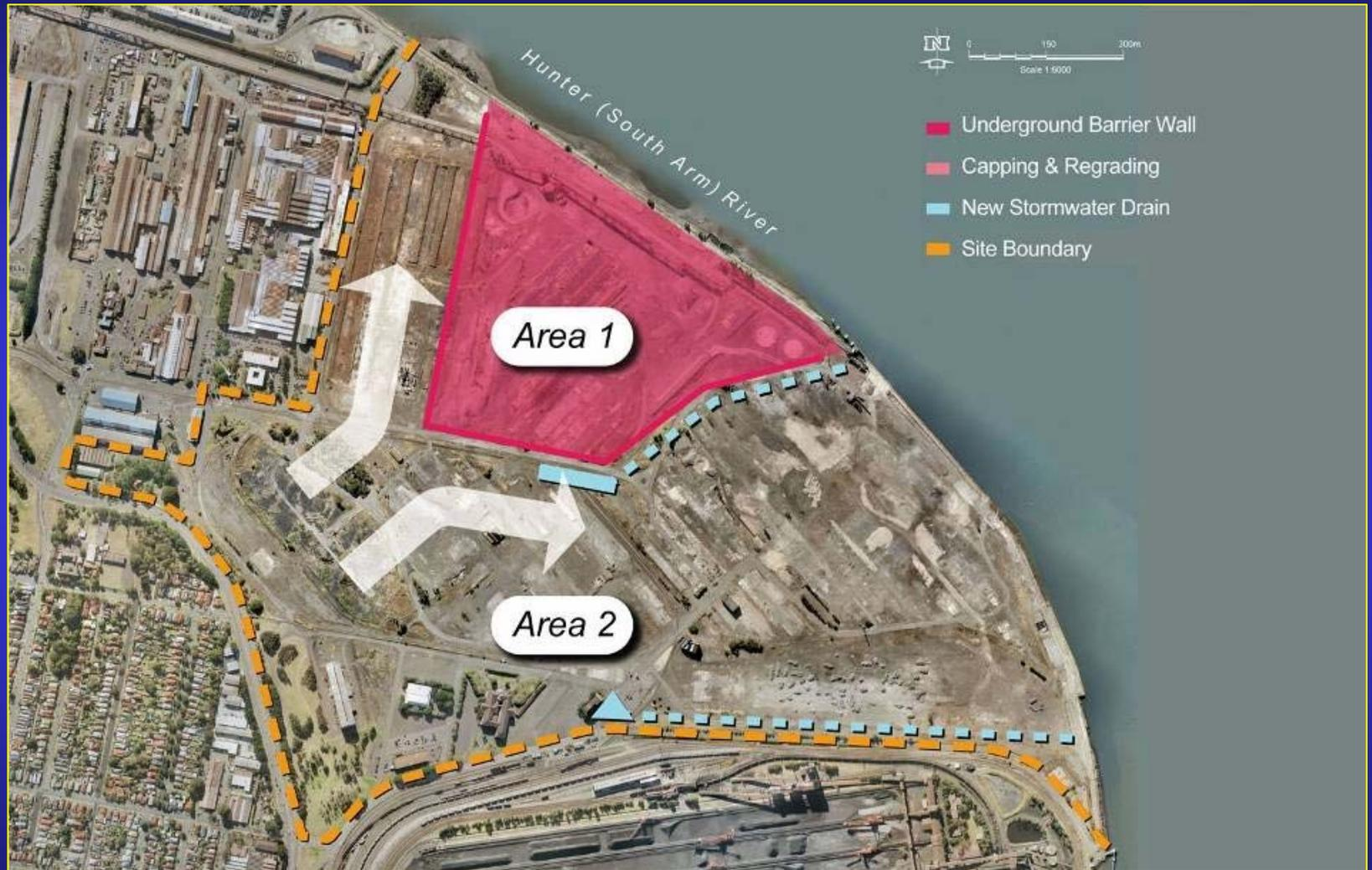
Principe de la barrière hydraulique amont (1)
