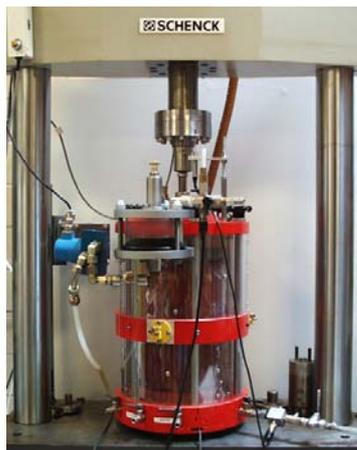
Éprouvettes : diamètre 160 mm
