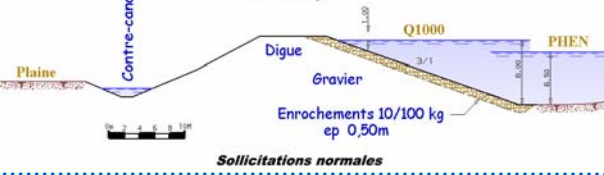
COUPE TYPE D'UNE BERGE DE RETENUE DU RHONE AMENAGE Aval de Lyon
