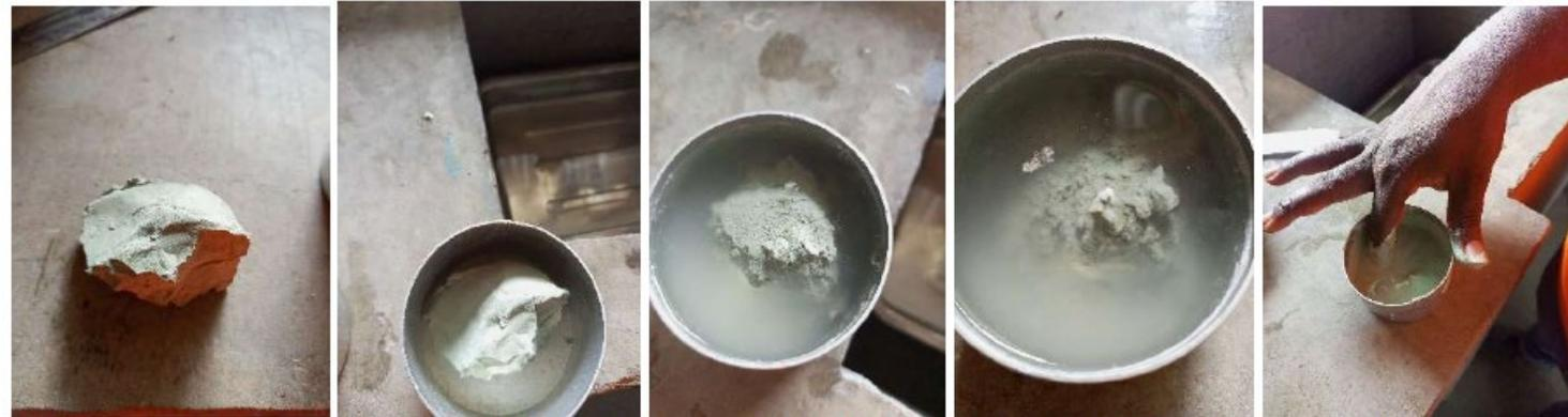
Marne SC7-23,40 m,  $R_c=7\text{mpa}$  Marne mise dans l'eau  $t=0$   $t=10\text{ mn}$  dans l'eau  $t=15\text{ mn}$  dans l'eau  $t=30\text{ mn}$  dans l'eau
