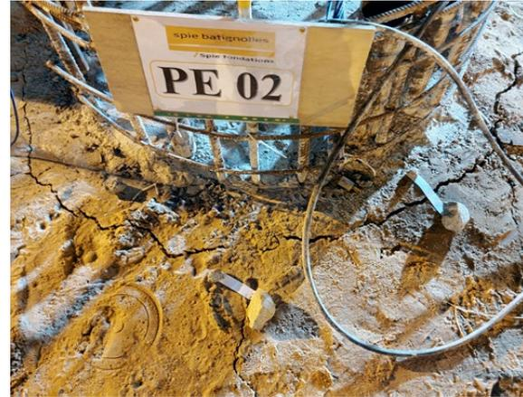
Fig. 19 : Rupture du frottement sur la partie supérieure
