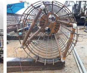
Fig. 13 : Montage du dispositif d'essai et des tubes d'injection dans la cage d'armature du pieu d'essai
