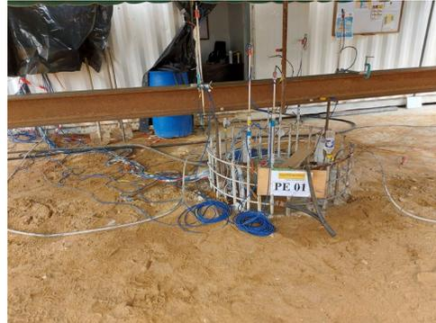
Fig. 15 : Système de contrôle d'essai sur PE01
