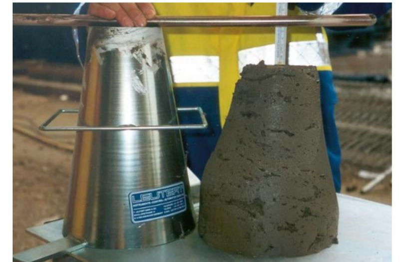
*Mortier de faible Slump < 10*
