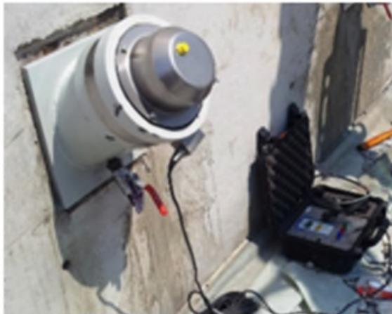
Photo 8.8 : Tête d'ancrage instrumentée avec protection de type P
