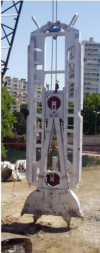
Benne lourde pour paroi moulée de 1 mètre d'épaisseur : poids 21,3 tonnes
