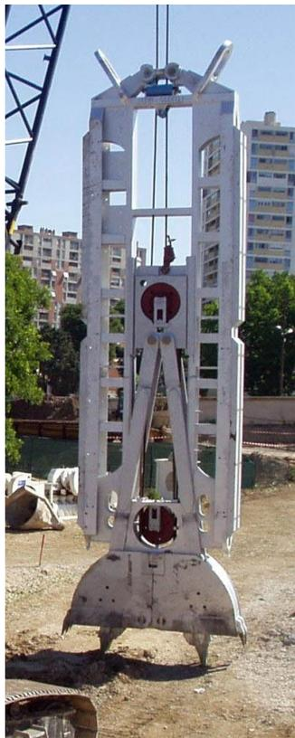
Exemple avec un panneau de paroi moulée d'un mètre
