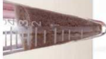
Contrôles de la boue Teneur en sable
