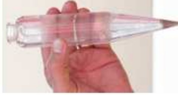
Contrôles de la boue Teneur en sable
