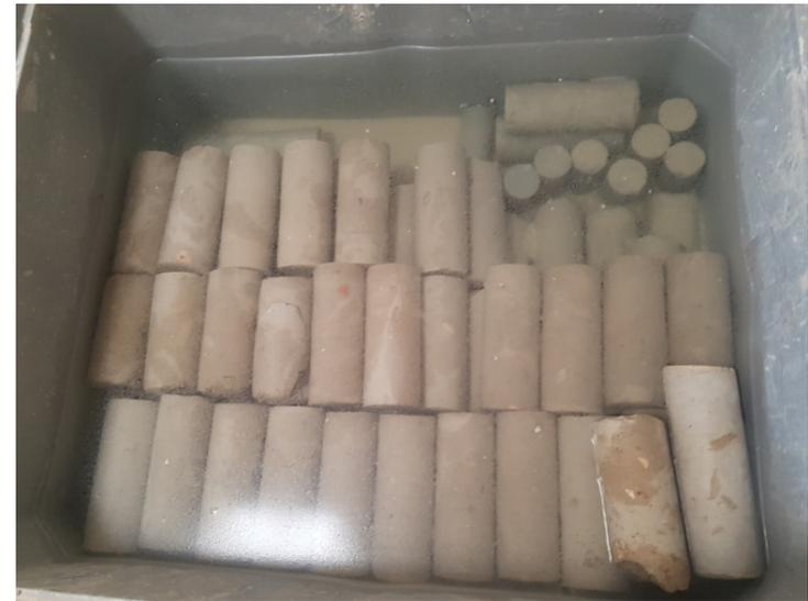
230 éprouvettes 10/20 et 130 éprouvettes 5/10
