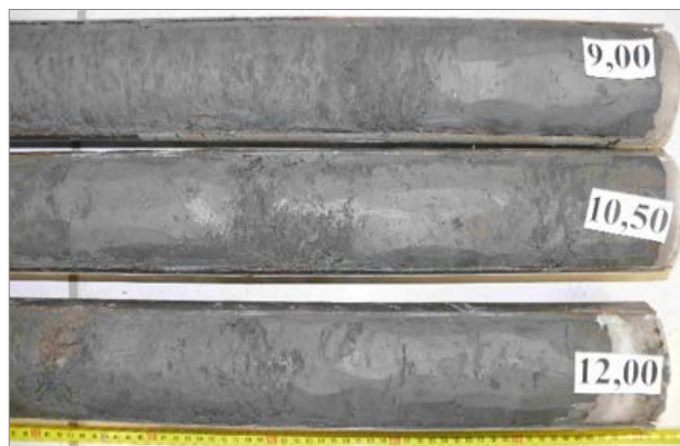
Figure 4 : Gains translucides (carottier triple) après ouverture. Extrémités arasées (à gauche) et extrémités paraffinées (à droite). Diamètre 90 mm. Photo Cerema.
