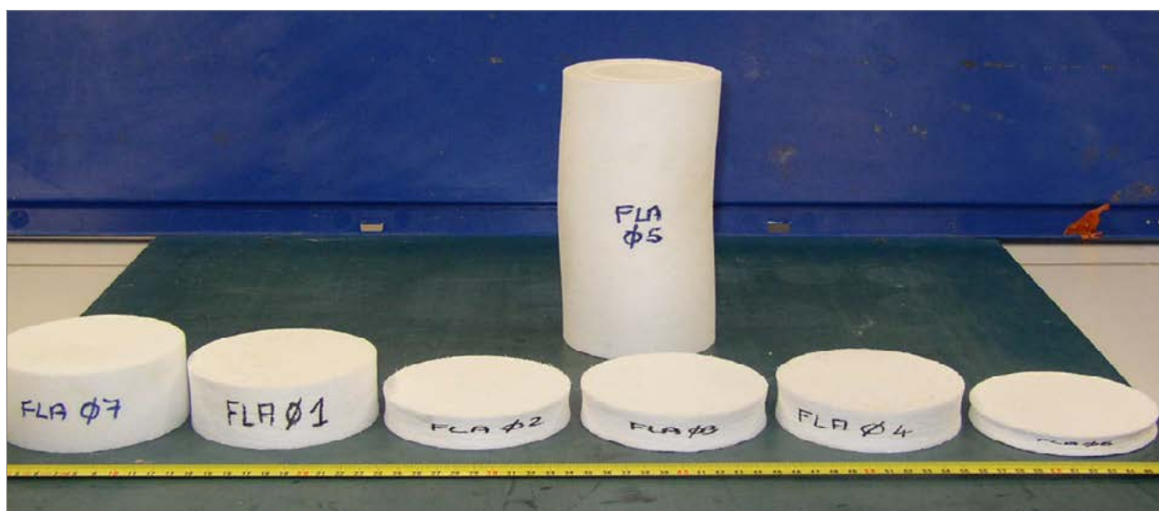
Figure 61 : Polystyrène expansé. Eprouvettes après essais. Exemples (Serratrice, 2017) A l'avant : essais de compression œdométrique Diamètre 107 mm. Hauteurs initiales 45 mm. A l'arrière : éprouvette de compression uniaxiale. Diamètre 85 mm, élancement deux
