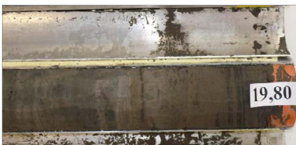
Figure 5 : Gains translucides (carottier triple) après ouverture. Bouchons intérieurs. Diamètre 98 mm. Photo Cerema.
