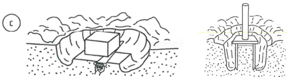
Figure 8 : Prélèvements par bloc ou à la boîte. Norme XP P94-202 (AFNOR, 1995).
