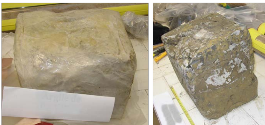
Figure 10 : Prélèvement par bloc sur une planche d'essai. Prélèvement manuel. Dimensions approximatives 250 x 300 x 300 mm. Photo Cerema.
