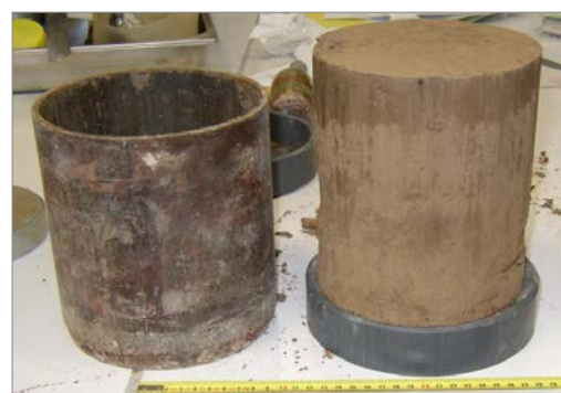
Figure 12 : Prélèvement par bloc dans un puits. Boîte munie d'une trousse coupante. Bouchons (en gris). Diamètre de l'échantillon 159 mm. Photo Cerema.
