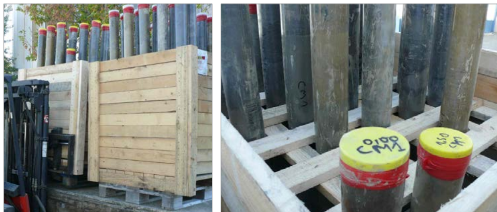
Figure 14 : Caisses pour échantillons longs transportés verticalement. Diamètres 90 mm. Photo Cerema.
