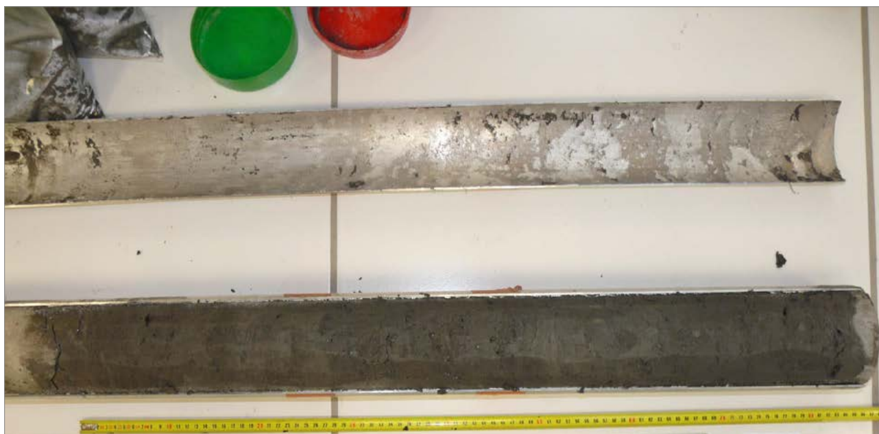
Figure 6 : Carottier poinçonneur à paroi mince en aluminium après ouverture. Trousse coupante à droite. Extrémités paraffinées et bouchons extérieurs. Diamètre 98 mm. Photo Cerema.
