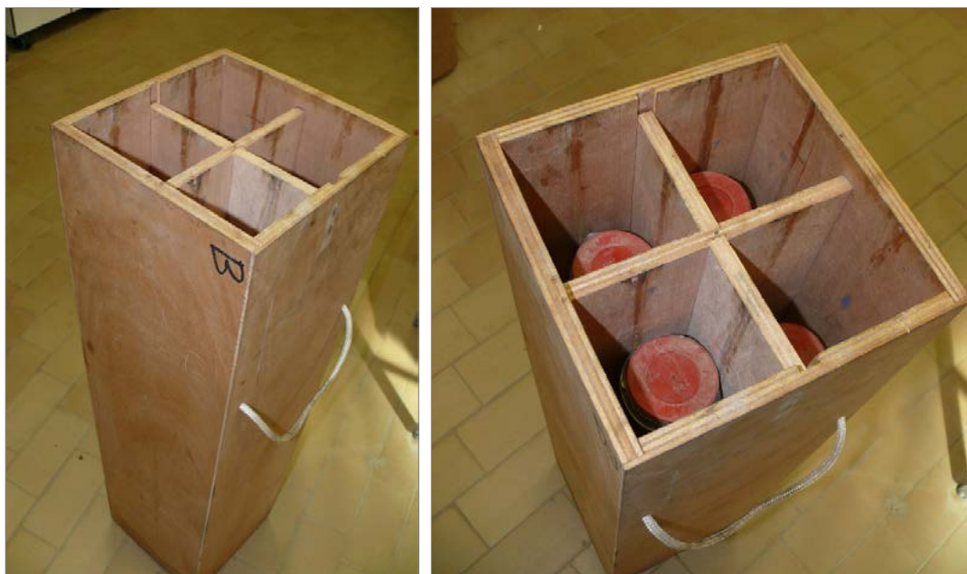
Figure 15 : Caisse pour échantillons longs transportés verticalement. Hauteur 120 cm. Photo Cerema.
