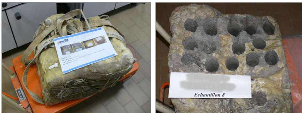
Figure 9 : Prélèvement par bloc en tunnel. Carottage au laboratoire. Dimensions approximatives 500 x 400 x 250 mm. Carottage en 50 mm. Photo Cerema.
