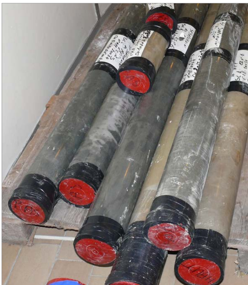
Figure 2 : Gains translucides (carottier triple). Bouchons et rubans adhésifs. Diamètres des échantillons 105 mm. Photo Cerema.
