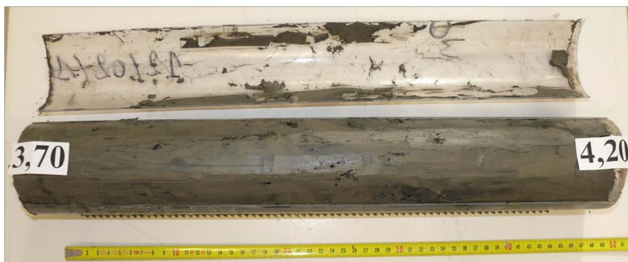
Figure 3 : Gaine translucide (carottier triple) après ouverture. Extrémité arasée (haut) et extrémité paraffinée (bas). Diamètre 76 mm. Photo Cerema.
