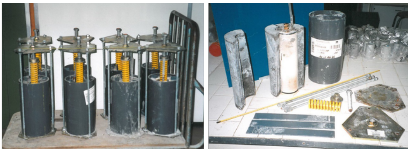
Figure 16 : Cellule T1 pour le conditionnement des échantillons carottés. En haut, huit cellules. En bas, une cellule ouverte. Diamètre de l'échantillon carotté 100 mm, hauteur 300 mm. Photo Cerema.
