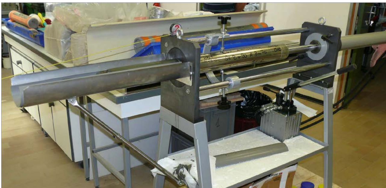
Figure 7 : Carottier poinçonneur à paroi mince en acier. Diamètre 82 mm. Extraction de l'échantillon à l'aide d'un "pousse carotte". Photo Cerema.
