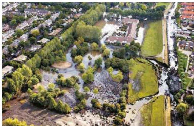
Glissement translationnel des digues de Vilnius (Stowa in Cerema, 2019)
