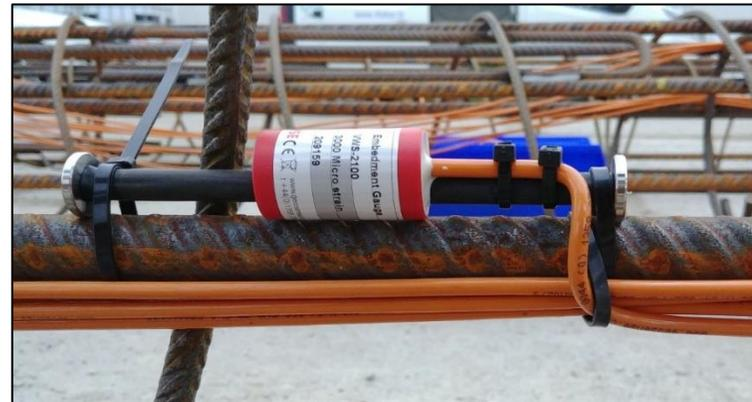
capteur à corde vibrante fixé sur un filant d'instrumentation par des colliers de serrage
