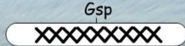
Structure tridimensionnelle utilisée dans des applications de géotechnique et de génie civil, permettant de maintenir un espace entre deux matériaux différents, notamment en vue d'assurer une fonction de drainage.
