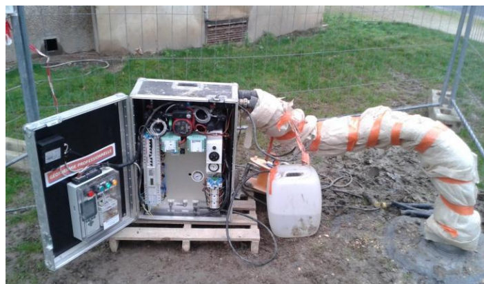
Figure 9 : Dispositif de test de réponse thermique (Ecome, 2015)
