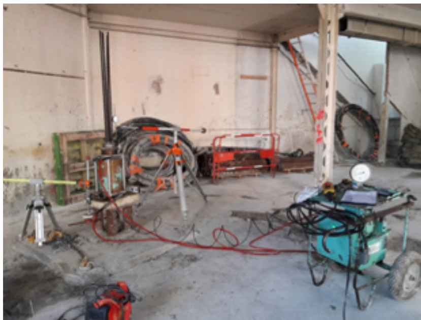
Photo 8.2 : exemple de dispositif pour essai à la rupture (© Spie Fondations)
