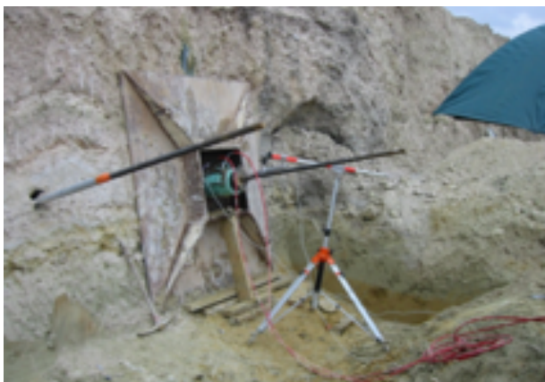
Photo 8.1b : massif de réaction en acier pour essai à la rupture (© Spie Fondations)
