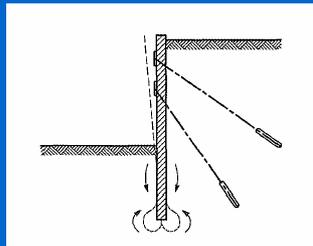
L'amplitude et la direction des contraintes de cisaillement de calcul doivent être compatibles avec celles utilisées pour la vérification de l'équilibre rotationnel
