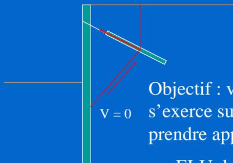
Objectif : vérifier que la réaction d'ancrage s'exerce suffisamment loin pour ne pas prendre appui sur l'écran
