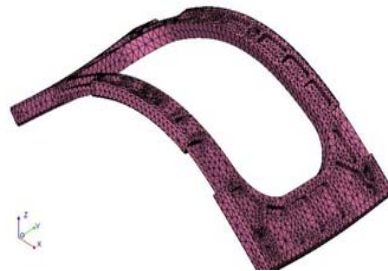
ARBAU T191 EVEC A-nrpt - Fréquence Mode 11 Valeur = 366.21 Hz Echelle de déformation 1 : 0.415954
