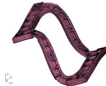
ARBAU T191 EVEC A-nrpt - Fréquence Mode 11 Valeur = 366.21 Hz Echelle de déformation 1 : 0.415954
