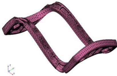
ARBAU T191 EVEC A-nrpt - Fréquence Mode 10 Valeur = 357.63 Hz Echelle de déformation 1 : 0.415954
