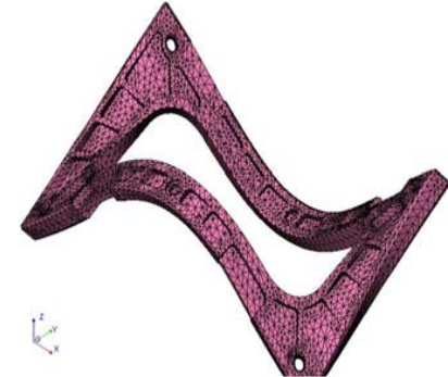
ARBAU T191 EVEC A-nrpt - Fréquence Mode 9 Valeur = 221.04 Hz Echelle de déformation 1 : 0.415954
