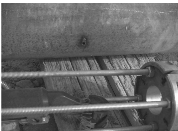
Figure 9. Essai préalable de perforation sur un tube extérieur
